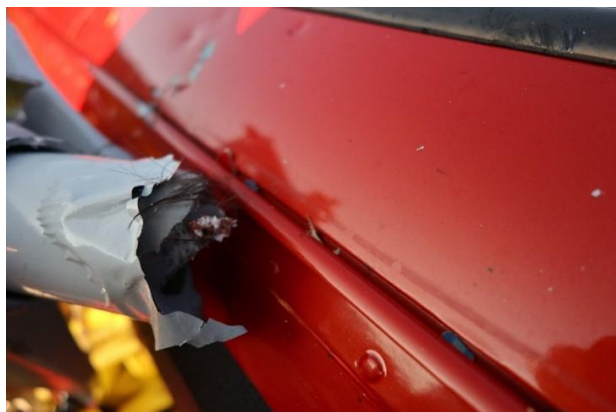
Figur 8: Bruddflate på rotormasten med menneskehår. Foto: SHK
