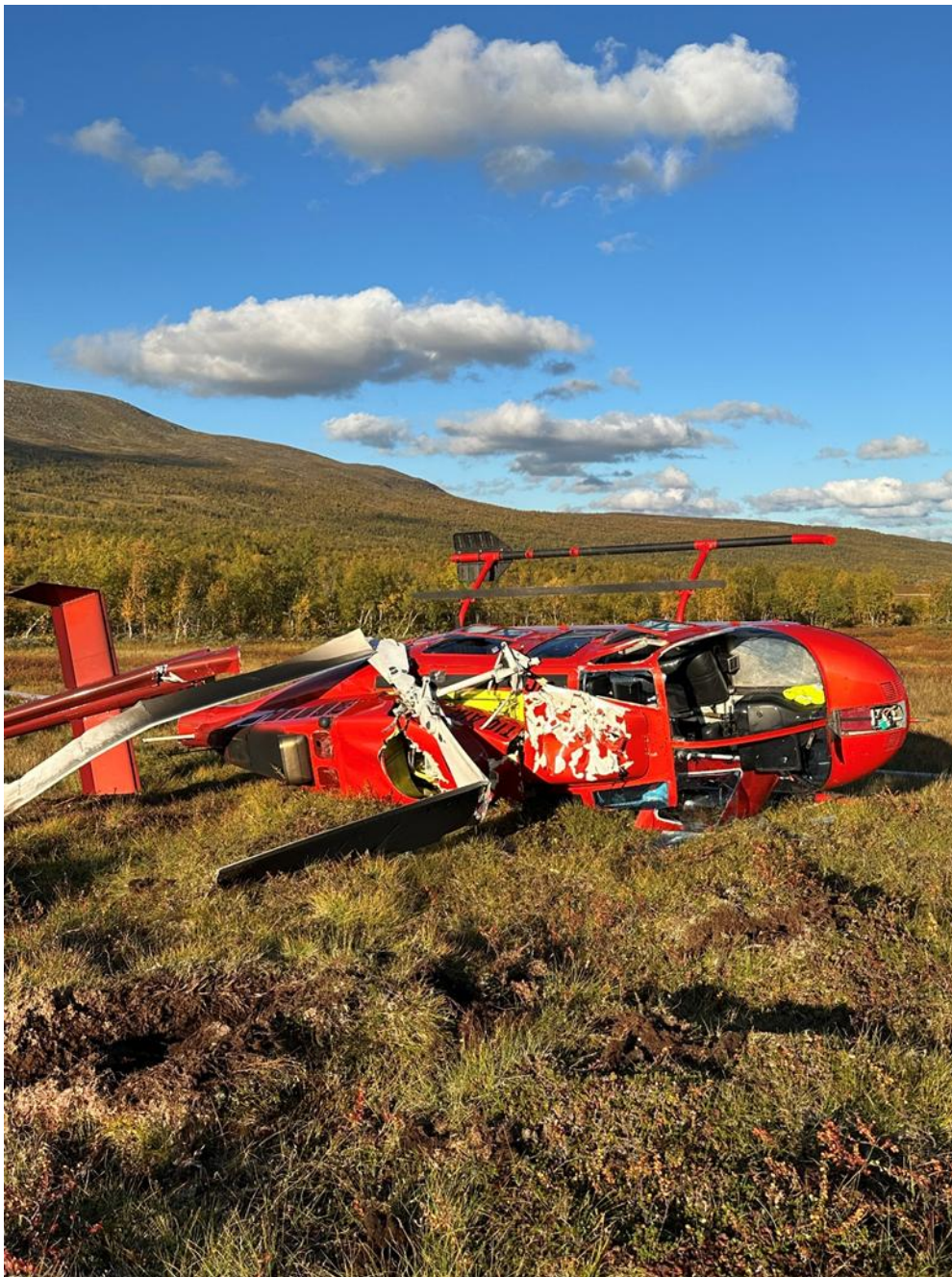
Figur 3: Helikopteret fikk skader på blant annet hovedrotor, rotormast, frontvinduer og halebom. Foto: SHK
