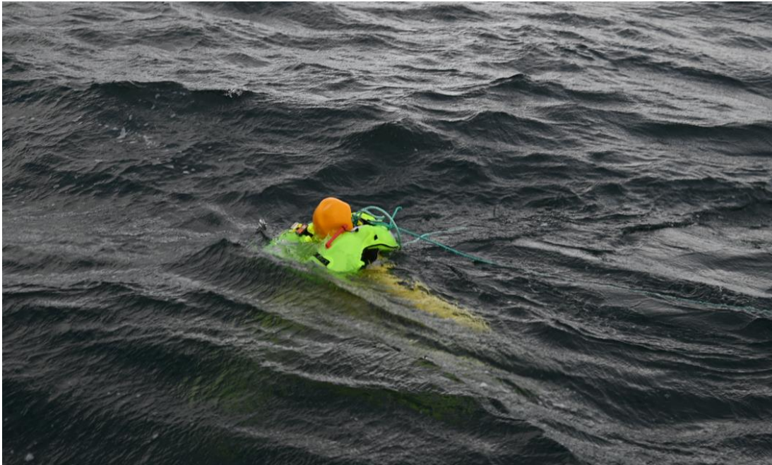
Figur 9. Bild där provdockan är utrustad med uppblåsbar flytväst med en flytkraft på 275 N.
