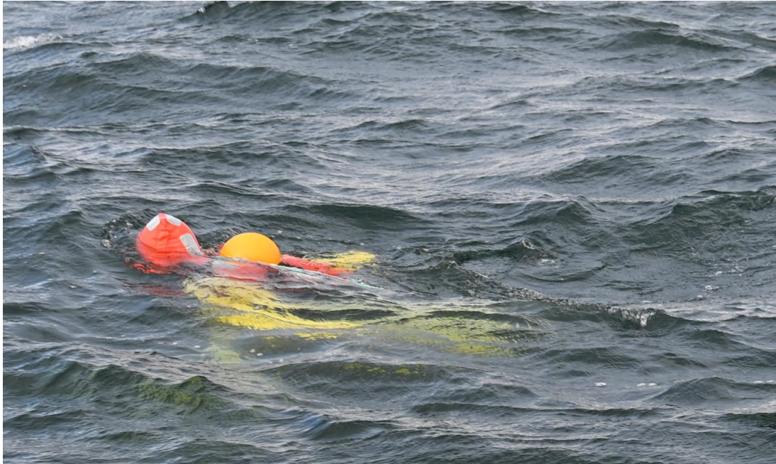
Figur 8. Bild där provdockan är utrustad med en uppblåsbar flytväst med en flytkraft på 165 N.
