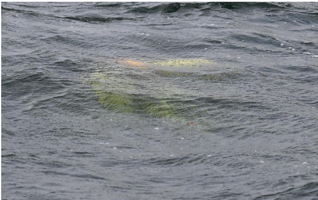
Figur 7. Bild där provdockan är utrustad med deplacerande (fasta flytelement som ger omedelbar flytkraft utan att behöva blåsas upp) flytväst med 50 N flytkraft.
