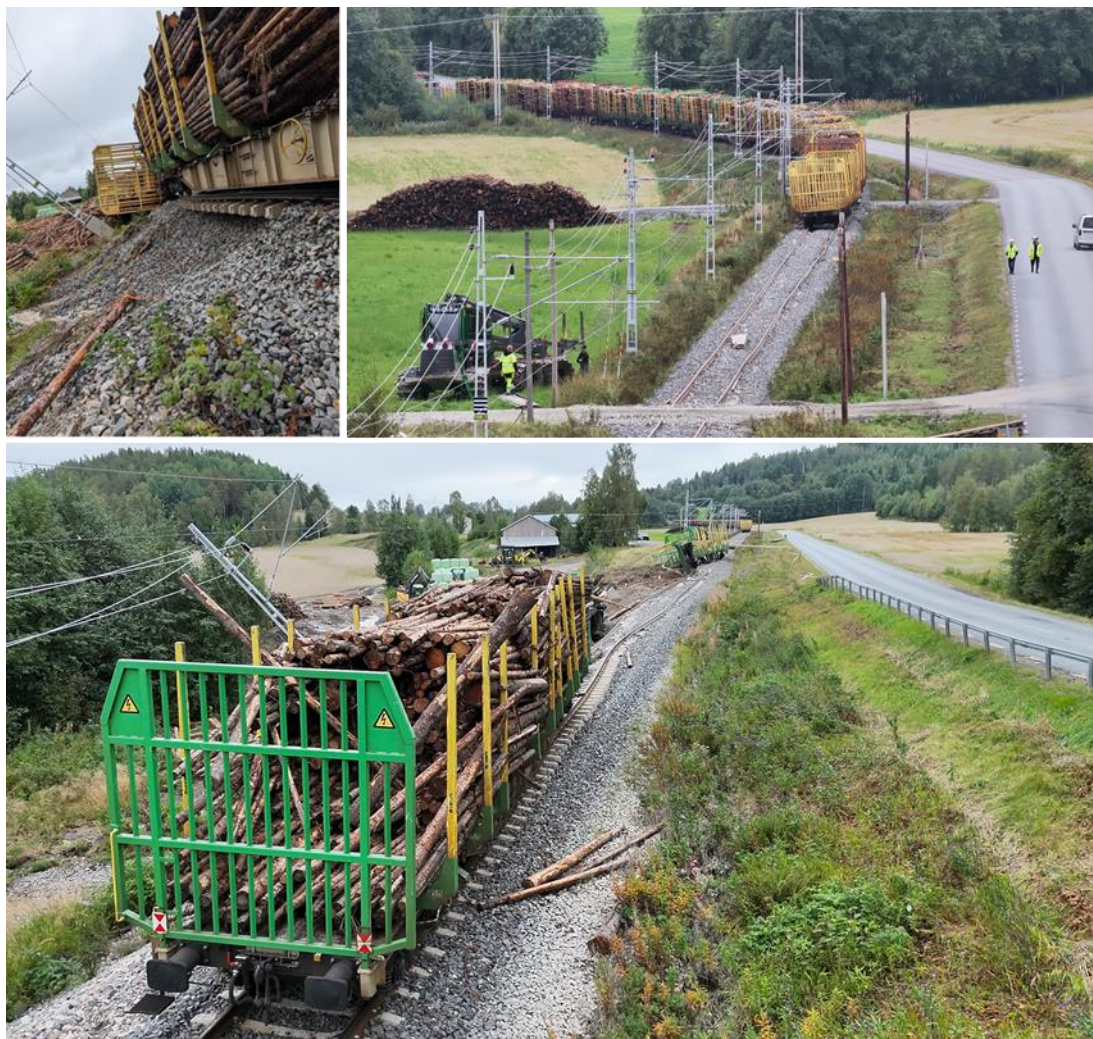
Figur 4. Den undre bilden visar olycksplatsen framåt från den sista vagnen i tåget. Bilden överst till vänster visar den underminerade banvallen under sista vagnen. Överst till höger framgår den främre delen av tåget och skadorna i spåret efter att flera vagnar rullat med urspårade. Foto: NRC Group.
