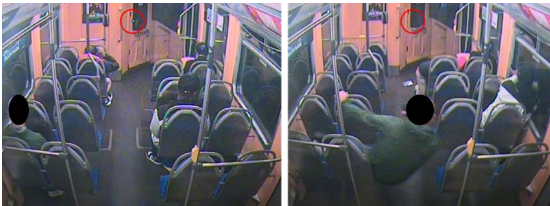
Figur 15. Bild till vänster visar ögonblicket innan spårvagnen går in i kurvan och till höger precis när spårvagnen gått in i kurvan. Resande kastas åt höger. En display i förarhytten skymts i samma ögonblick, föraren som också kastades åt höger, se de båda röda ringarna. Källa: Göteborgs spårvägar.
