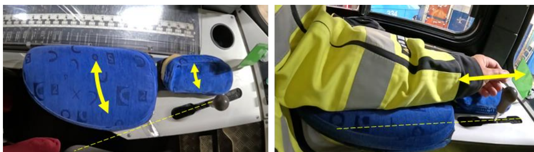
Figur 10. Handkontroll och armstöd i en M31. De gula markeringarna visar hur armstödet kan justeras. Handkontrollen är i neutralläge. Till höger visas armstödet vridet och justerat i linje med handkontrollens rörelse.
