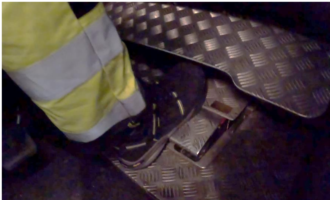
Figur 13. En fot som trycker ned fotpedalen i lyftläge och aktiverar säkerhetsgreppet. Bilden är från vagn 352 som har använts som referensvagn.
