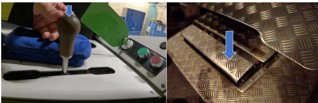
Figur 12. De blå pilarna visar hur säkerhetsgreppet aktiveras. Säkerhetsgreppet kan aktiveras genom att handkontrollen trycks ner eller genom att hålla fotpedalen nertryckt i lyftläge.
