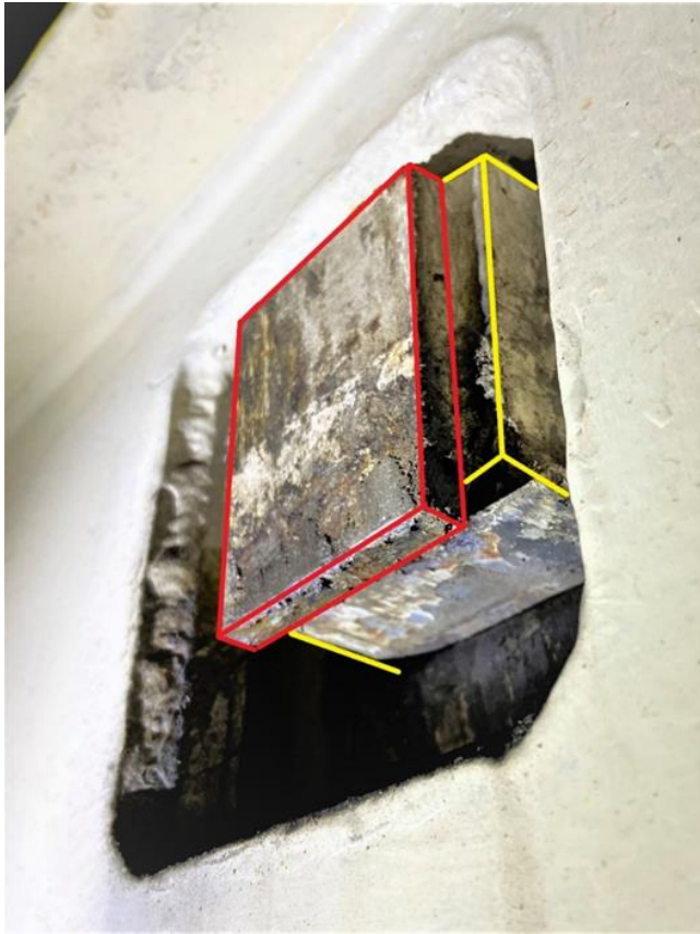
Figur 27. Låskilarna till plattformarna på BALTIC QUEEN. Låskilen har en påsvetsad plåt i änden som går ner en bit. Detta gör att låskilen inte kan dras ur förrän plattformen lyfts så högt att plåten går över motsvarande tröskel i låshuset.
