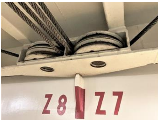
Figur 28. Linskivehusen på BALTIC QUEEN (vänster) och SILJA SYMPHONY (höger). Plåtarna som håller linskivan är helsvetsade i grova balkar på tre av fyra sidor.
