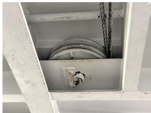
Figur 28. Linskivehusen på BALTIC QUEEN (vänster) och SILJA SYMPHONY (höger). Plåtarna som håller linskivan är helsvetsade i grova balkar på tre av fyra sidor.
