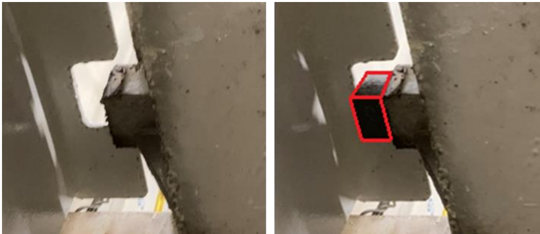
Figur 5. Låskilarna till plattformen. Bilden till vänster visar när låskilen är indragen och bilden till höger när den är fullt utskjuten i låst läge. Slaglängden var 50 mm. Bilden visar plattformen i sitt nedre läge.
