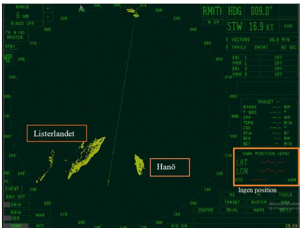
Figur 15. VDR-inspelning av X-bandradar från kl. 05.02. De gula fälten på vardera sida av den gröna kurslinjen är land. Notera att i högra nedre hörnet (LAT, LON) presenteras ingen GPS-position. Rutor och vit text infogade av SHK.
