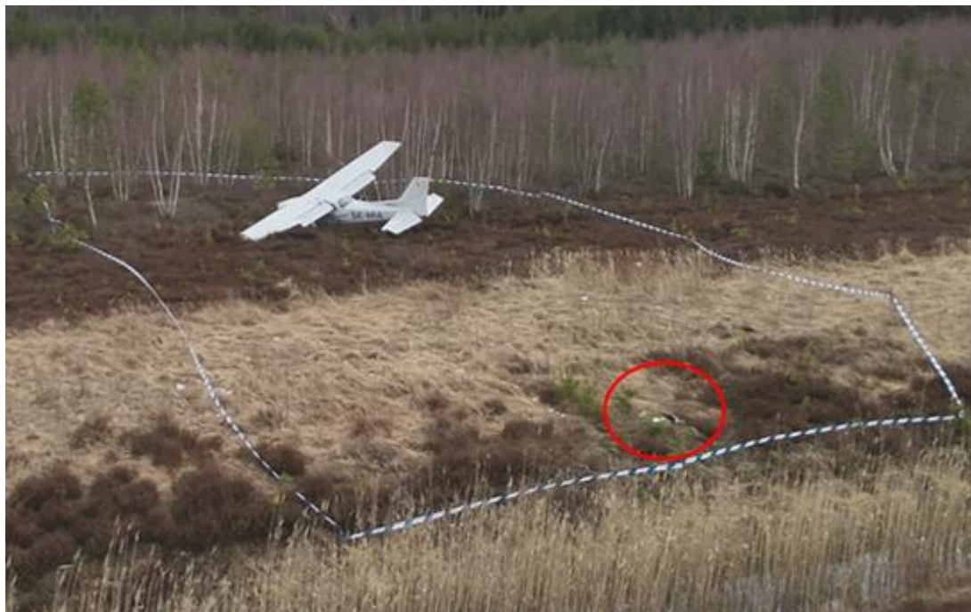
Figur 10. Bild av flygplanet sett mot öster. Det avslitna noslandstället markerat med röd cirkel.
