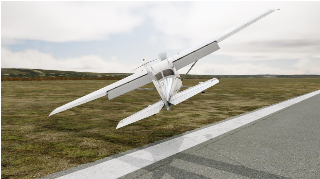
Figur 8. Med hög motoreffekt lämnar flygplanet banan åt vänster. Tippvinkel 10 grader nos-upp och bankningsvinkel 25 grader.
