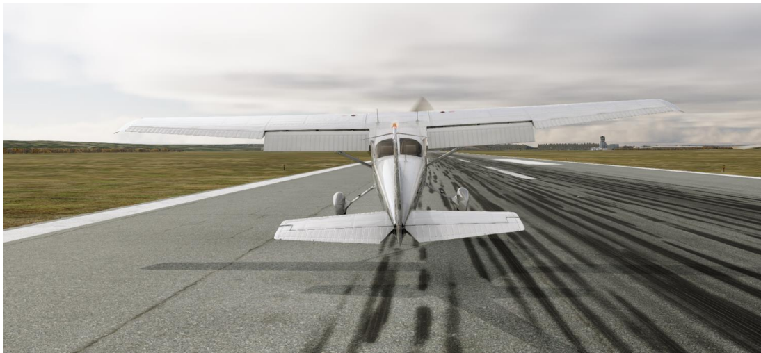
Figur 7. Efter en studs påbörjas ett omdrag. Farten är omkring 30 knop och tippvinkeln 12 grader nos-upp.
