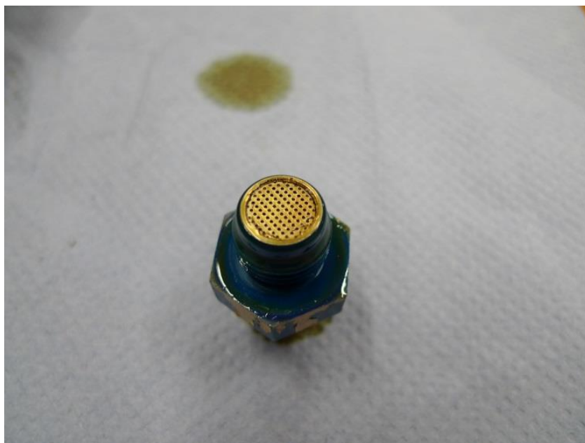
Figur 10. Filter P/N 50-075-1. Vid undersökningen var filtret fritt från visuella föroreningar
