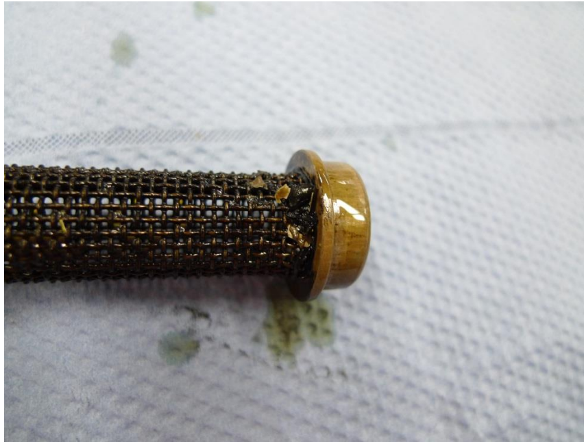
Figur 5. Huvudtransmissionens grova nätsil med föroreningar av tätningsmedel och färgrester.
