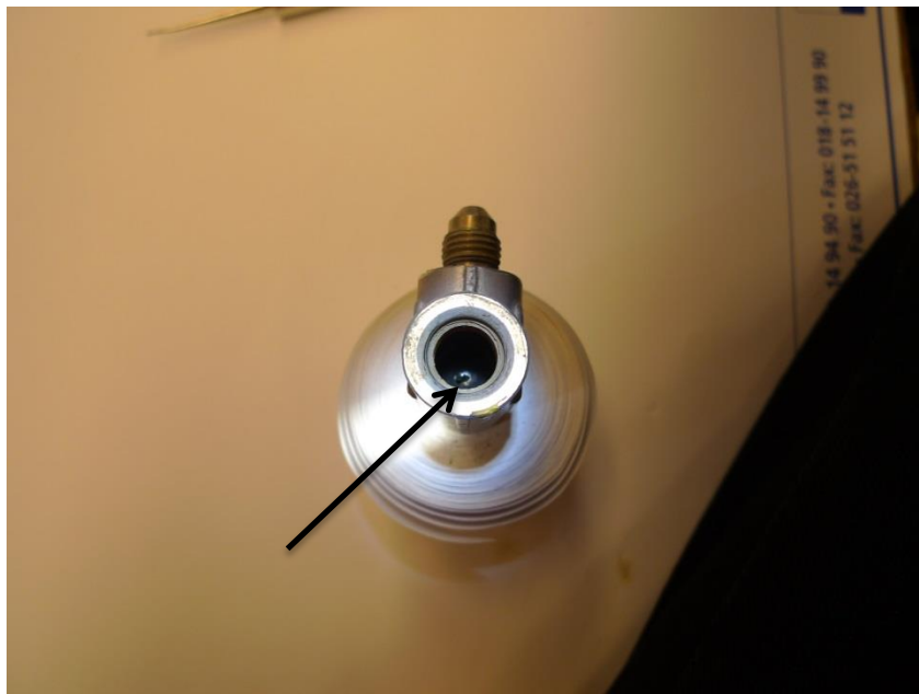
Figur 6. Munstycke P/N 206-040-244-001, föroreningen syns vid pilens spets.
