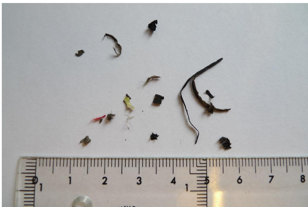
Figur 4. Föroreningar från filterhuset (nätfilter) på huvudtransmissionen, rester av o-ringar, tätningsmedel, textilier och färg.
