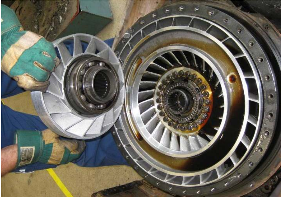
Fig. 10 Växellådans konverter demonterad utan uppvisade smältor eller skador.
