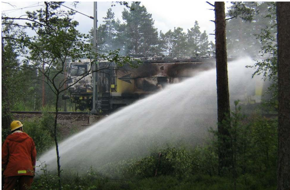
Fig. 4 Vattenbegjutning av SPR 3208B med vattenkanon.
