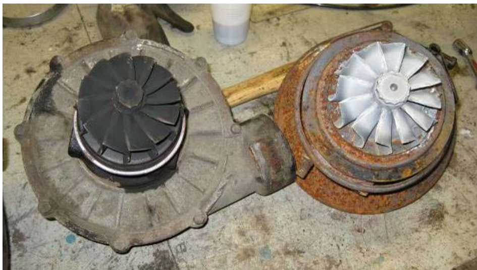
Fig. 13 Bild på turboaggregat. Det vänstra aggregatet kommer från en motor som inte varit utsatt för brand. Man ser att huset som är av aluminium finns kvar samt att vingarna är sotiga från motors avgaser.
