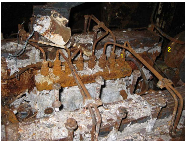
Fig. 12 Motorn på SPR 3208B. Insprutningspumpen sitter mitt på motorn, en av muttrarna (1) som håller spridarröret på plats satt löst. Turbokompressorn sitter till höger i bild (2) några centimeter från insprutningspumpen.
