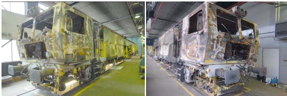
Fig. 5a-b Värmeöverkan från branden sett från sidorna av arbetsmaskinen.
