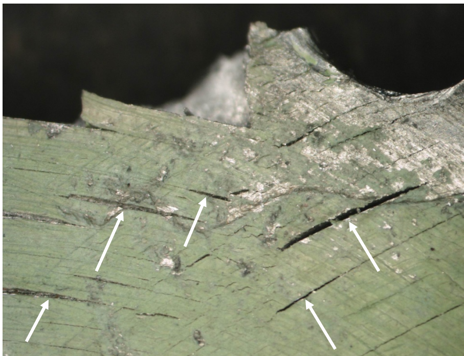
Bild 23. Exempel på mikrosprickor i slipsår
