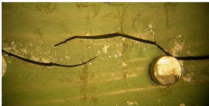
Bild 27. Exempel på spricktillväxt genom "överhopp"
