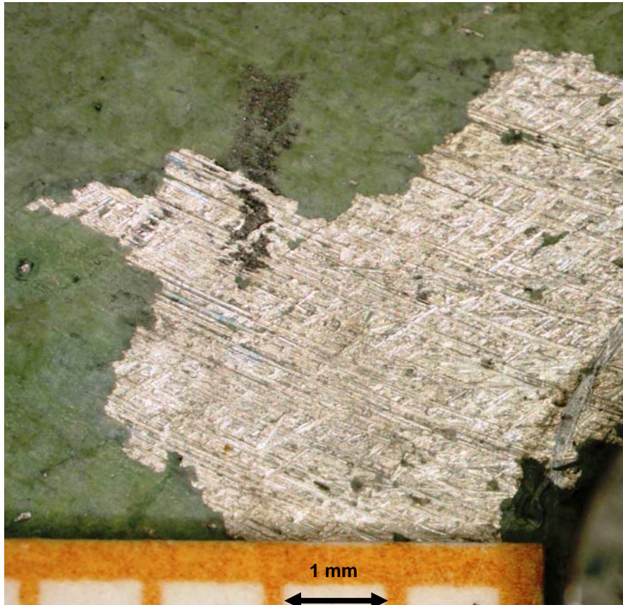
Bild 21. Slipsår mellan nithål
