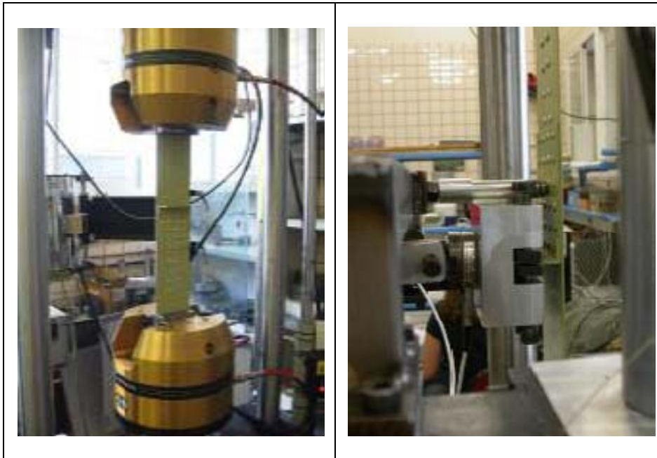
Bild B15. Utmattningsprov i en Belastningsriktning
