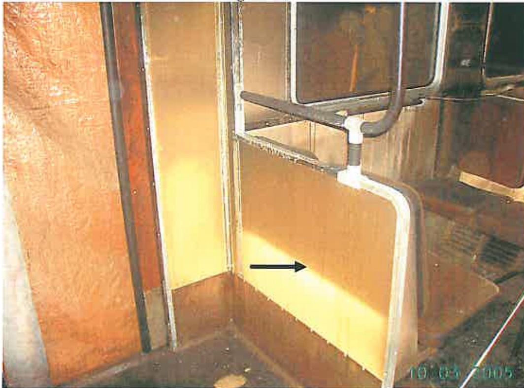
Figur 8 Bilden visar markeringen (sotlagring) av det varma rökgaslagret och hur långt det har sjunkit ner mot golvnivå. Nivån ligger på ungefär 0.7 m från vagnens golv. Liknande tecken kunde observeras i andra delar av vagnen.
