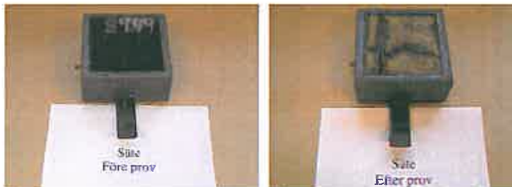
Figur 3 Bilder av sätesprovkropp före och efter provning i konkalorimeter.
