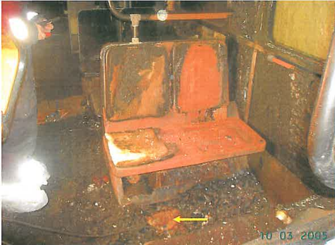
Figur 9 Bilden visar hur branden har spridits från hål i golvet (gul pil) och vidare upp till sätet och väggen panelen.
