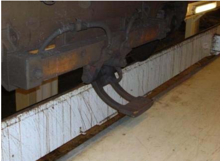
Fig. 13 Strömavtagare med kraftkablar.
