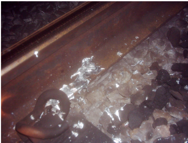
Fig. 22 Aluminiumfilm som bildats längs rälsfoten och stänk i ballasten.
