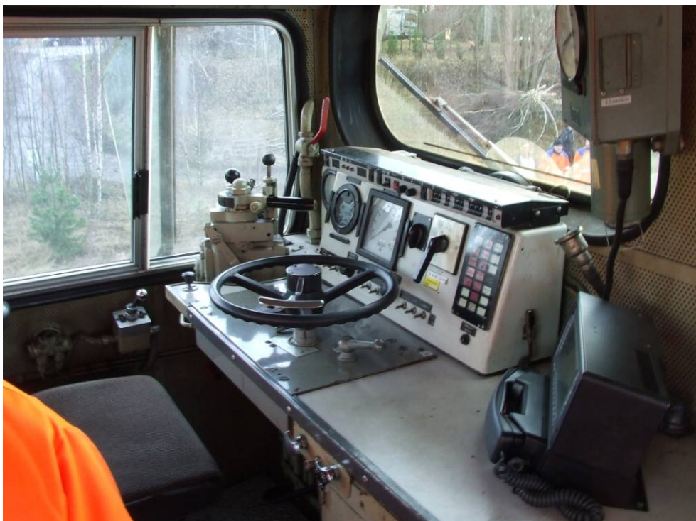
Fig. 12 Lokets förarplats. Ratten mitt på bordet används för motorpådrag. Till vänster om ratten finns ett handtag ovanpå en apparat. Detta handtag är kontrollen för tågbronsen med vilken föraren kan manövrera bromsen i hela tågsättet. Något bakom handtaget, närmare fönstret finns ett mindre handtag med vilken föraren kan manövrera enbart lokets broms. Det röda något högre och längre fram, placerade handtaget är en nödbroms.
