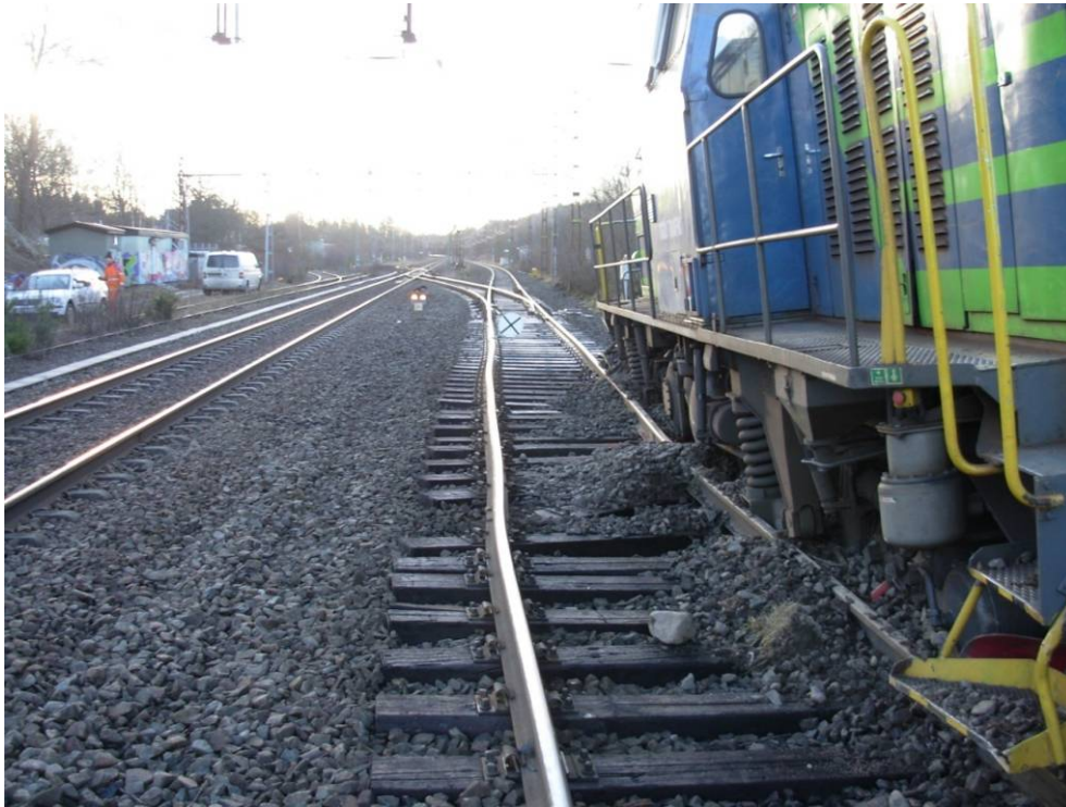
Fig. 4 Bilden visar hur lok 317 hade stannat så att det inkräktade på utrymmet för spår 3.
