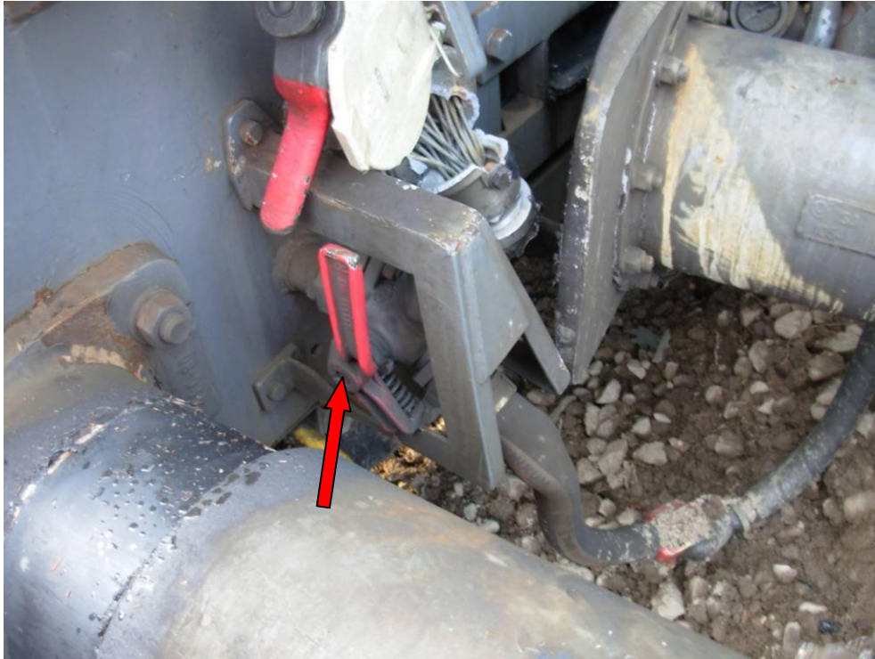
Fig. 9 Bild på kopplingsventilen på lok 318. Ventilen är uppfälld.
