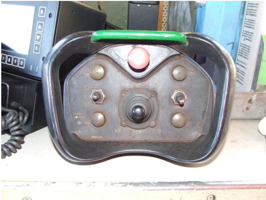
Fig. 11 Den radiostyrningsenhet som användes för att radiostyra lok 318.
