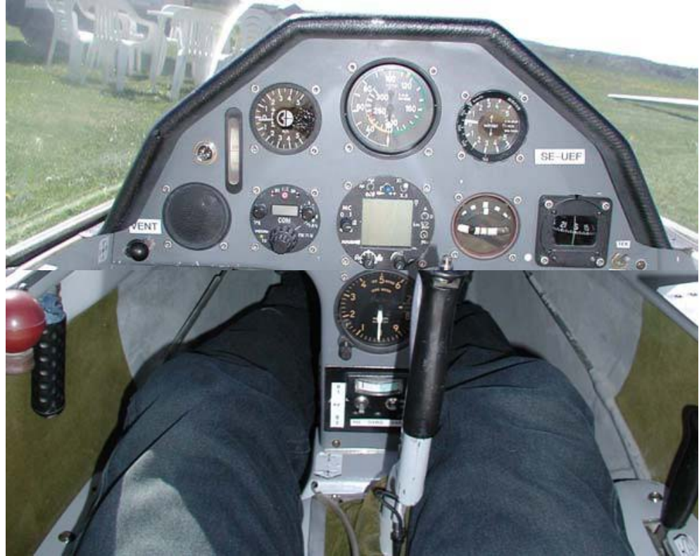
Bilden visar förarplatsen i SE-UEF. Spaken nere till höger i bild är landstallsreglaget. Spaken till vänster i bild, framför den röda kulan för huv-öppning, är luftbromsreglaget.
