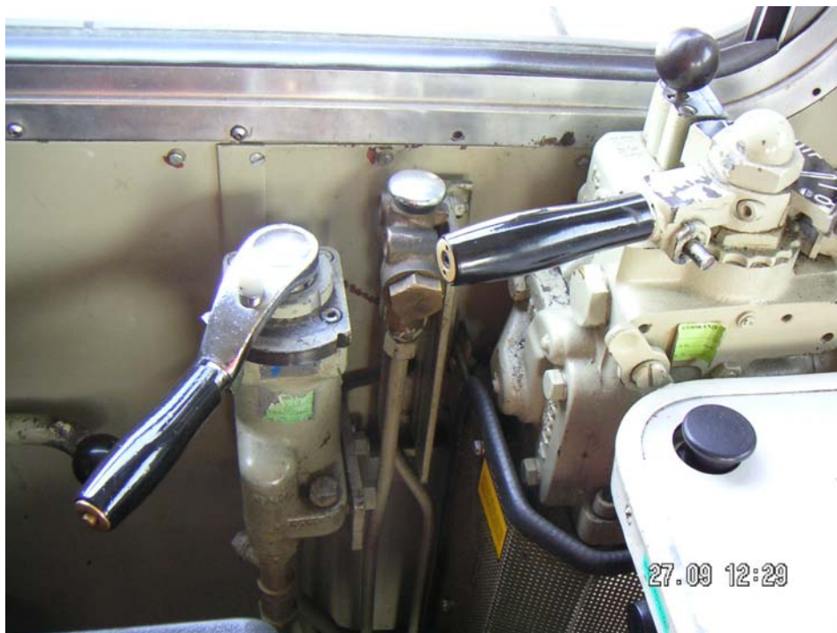
Fig. 7: Till vänster syns bromsventilen för lokbromsen som ligger för läge full broms. Till höger syns tågbrömsventilen som ligger i nödbroms (tömd huvudledning). Nödbroms ger inte mer än full broms.
