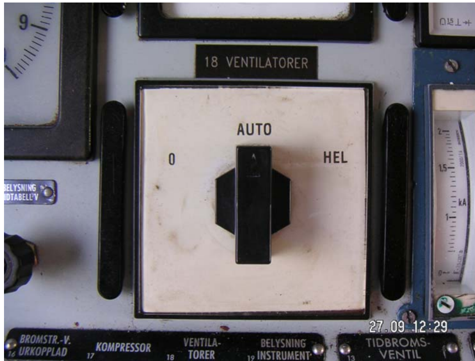
Fig. 6: Strömställare för traktionsmotorventilator ligger i läge för automatisk ventilation (hel ventilation när det behövs, halv annars). En förutsättning för att loket ska köra är att traktionsmotorventilatorerna går.
