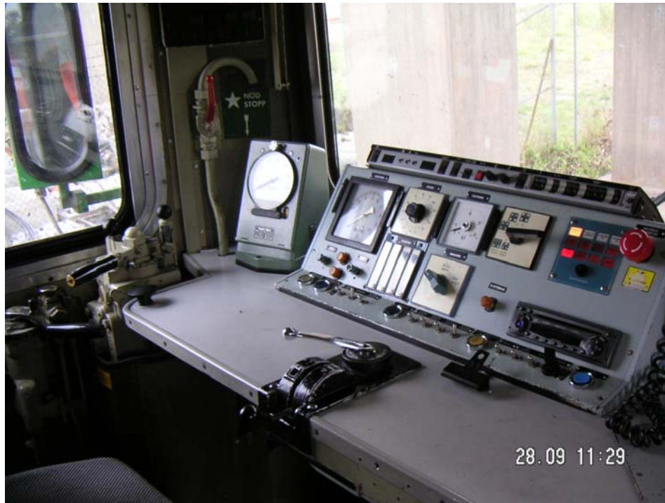
Fig. 4: Bilden visar förarplatsen på lok 1178. Mitt i bild, längst bak på förarbordet, syns strömpådraget. Framför denna finns omkopplaren för fram- och back(környckeln) och framför denna strömställare (se fig. 5) . Längst till vänster syns tågbrömsventilen och snett nedför denna kan lokbrömsventilen anas (fig. 6).
