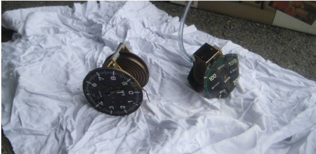
Fig.5. Höjdmätare respektive fartmätare.
