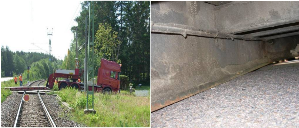
Bild 8a och 8b. Släpet fastnade mot asfalten.
