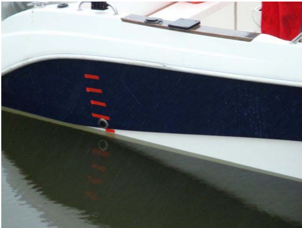
Fig 9 Länsöppningens läge till vattenytan före provkörning
