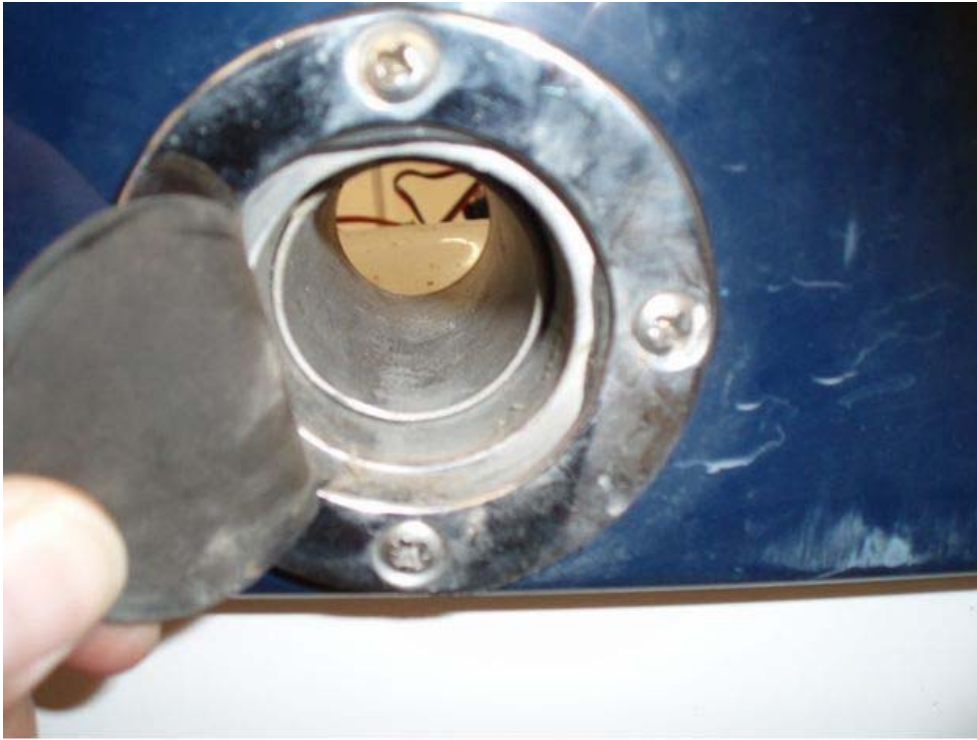
Fig. 5 Länsöppning i skrovsida
