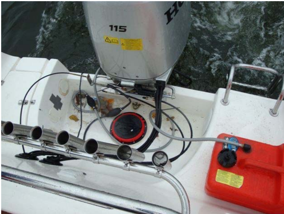
Fig 6 Motorbrunn med skruvlucka
