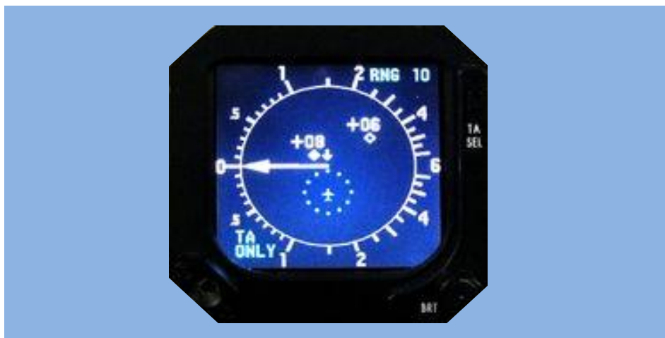
Bild 3. TCAS-display av samma typ som i ETS 612, där TCAS integrerats i VSI-displayen.
