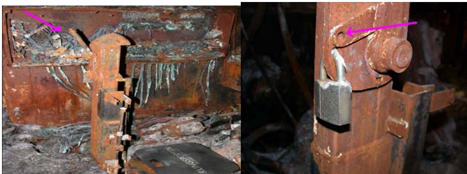
Fig. 6a-b Länkarm för reglering av växellådans i- och urläge.
