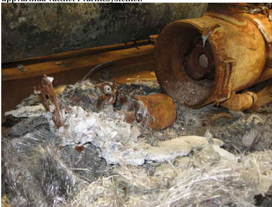
Fig. 13 Den brandpåverkade värmaren.
