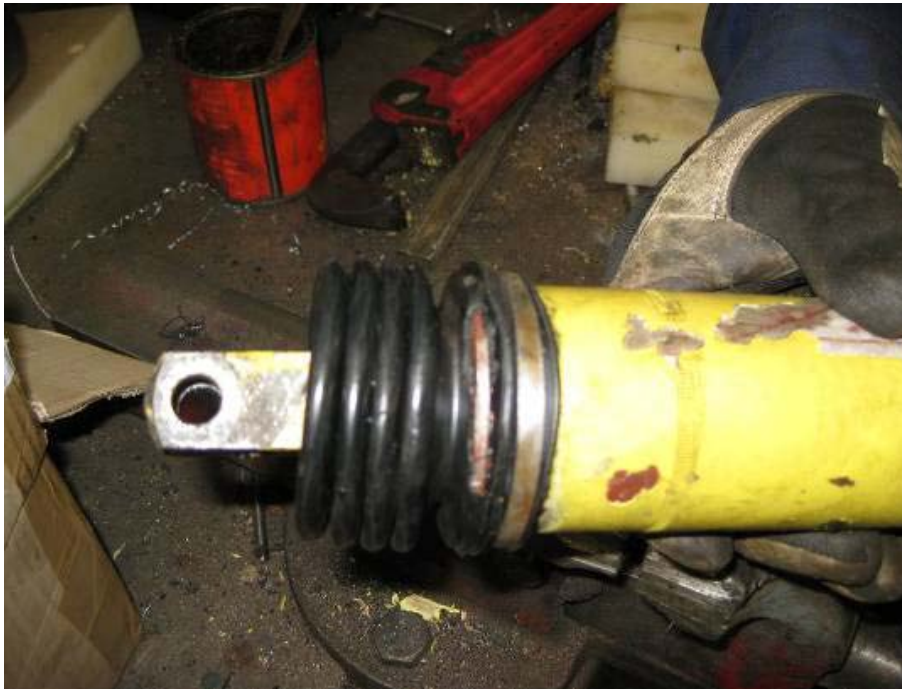
Fig. 11 Den skadade gummidamasken på kopplingscylindern till främre boggin.
