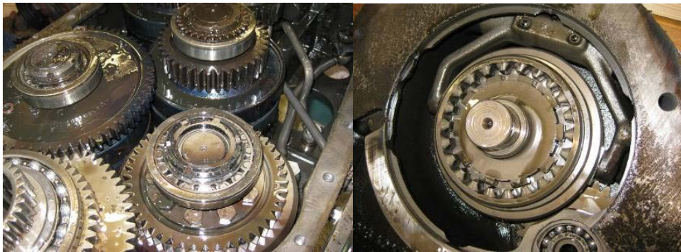
Fig. 9a-b. Växellådans drev utan påverkan av slitage.
