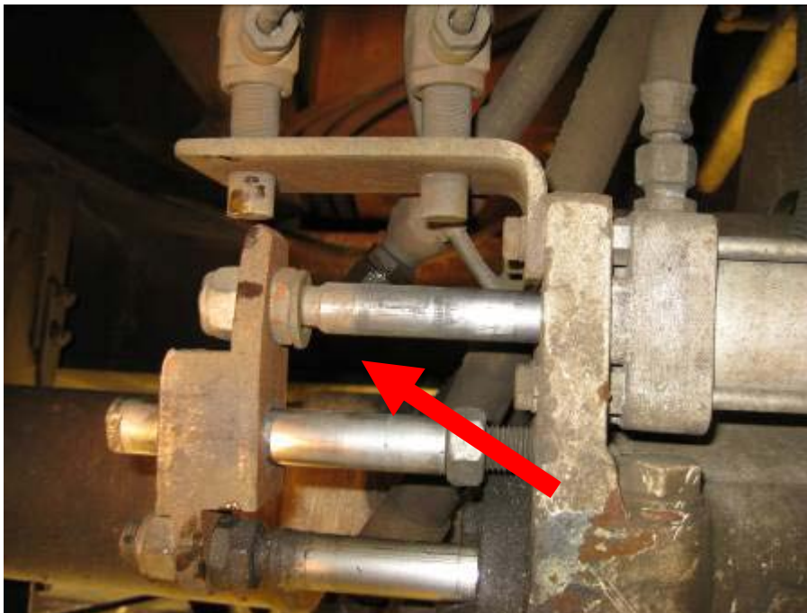
Fig. 12 Lös styrpinne vid inkoppling till hydraulmotor nr 2.
