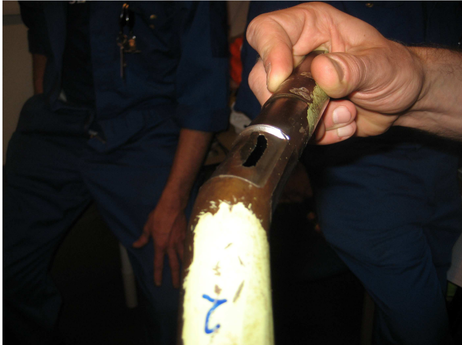
Figur 3: Det beskadigede brændselsolierør.
