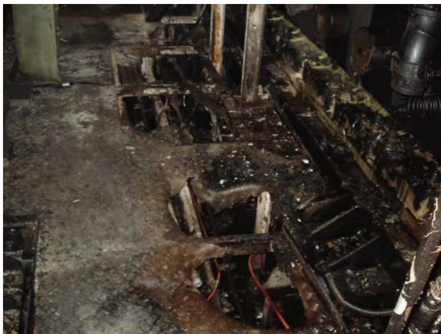
Figur 4: Smeltede dørklader ved hjælpemaskine nr. 2
