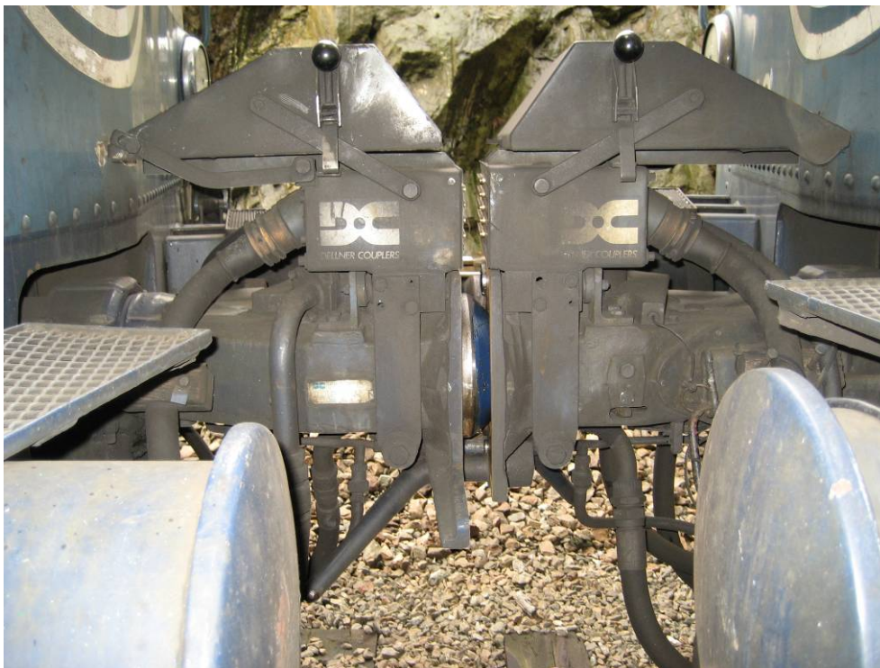
Fig. 6. Kopplens läge efter självavkoppling vid undersökningen i Älvsjö den 18 mars 2008.
