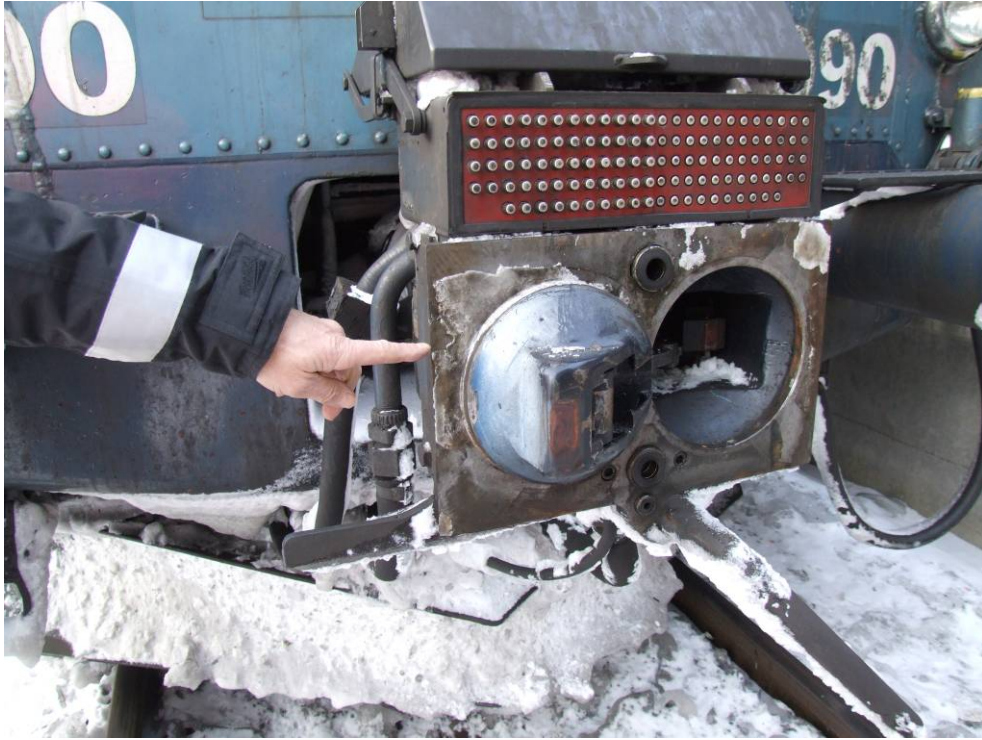
Fig. 2. Bilden visar isbeläggning på kopplet på X1 3090 i den ända där självavkopplingen skedde.
