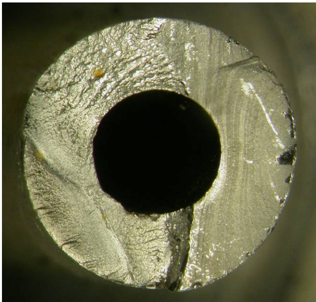
På höger brotthalva syns ett 60-tal rastlinjer. På vänster brotthalva kan inga rastlinjer skönjas.
