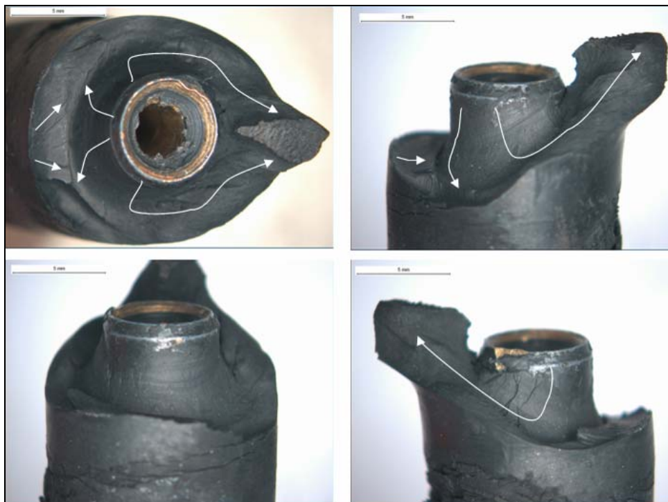
Ventilbrottyta i olika vyer. Sprickans tillväxtriiktning har pilmarkerats
