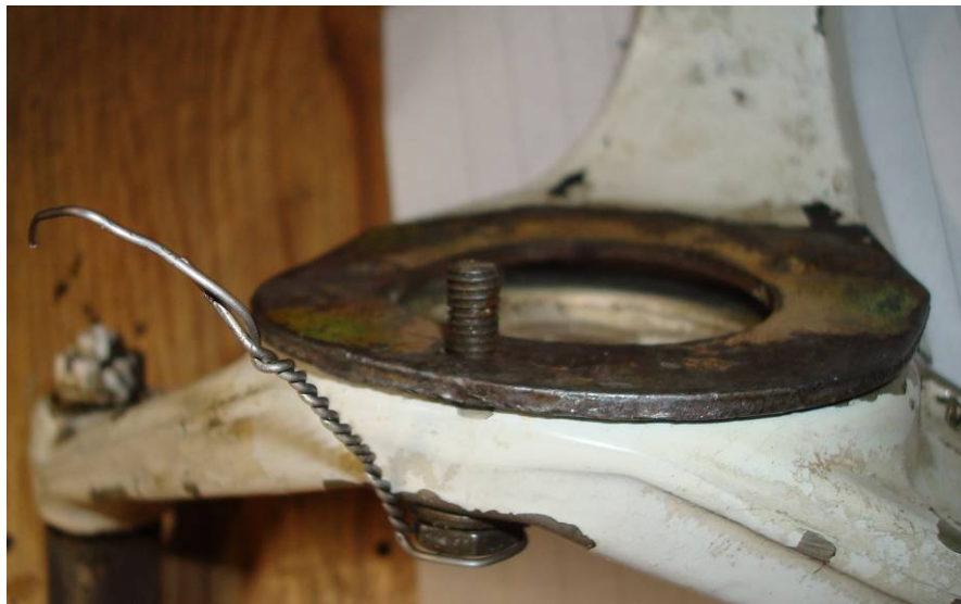
Styrok, centreringskam med kvarvarande bult
