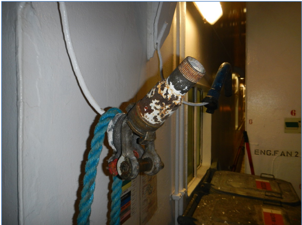
Figur 19. Vattenadaptorns placering vid skottet på styrbords sida.
