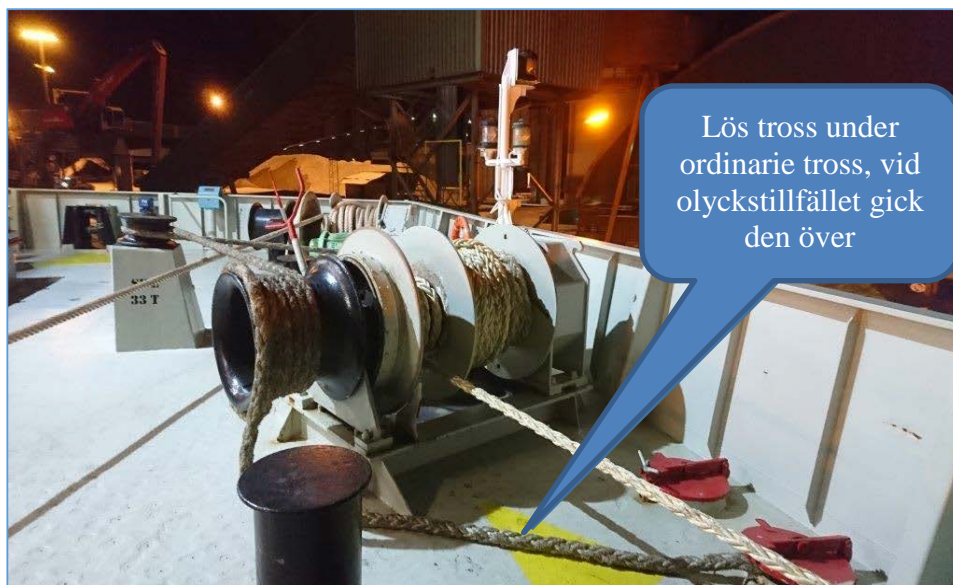
Figur 9. Förtöjningsvinsch och luckor till förråd för tross.
