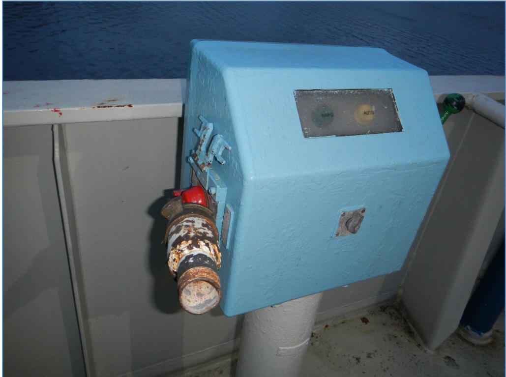
Figur 18. Manöverspaken låst i hög hastighet med vattenadaptorn.
