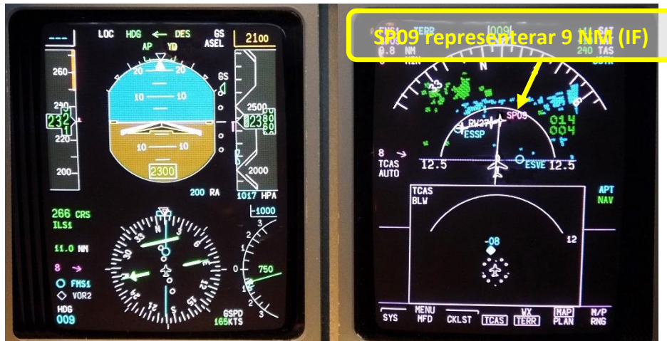
Figur 9. Bild tagen från simulatort av vänster pilots (PFD och MFD) med ett kartomfång av 25 M.
