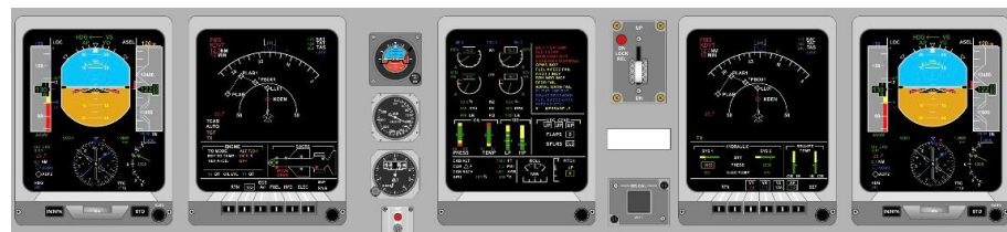
Figur 8. Presentation av skärmarna i cockpit för Embraer 145. Bild: Embraer Operations Manual.
