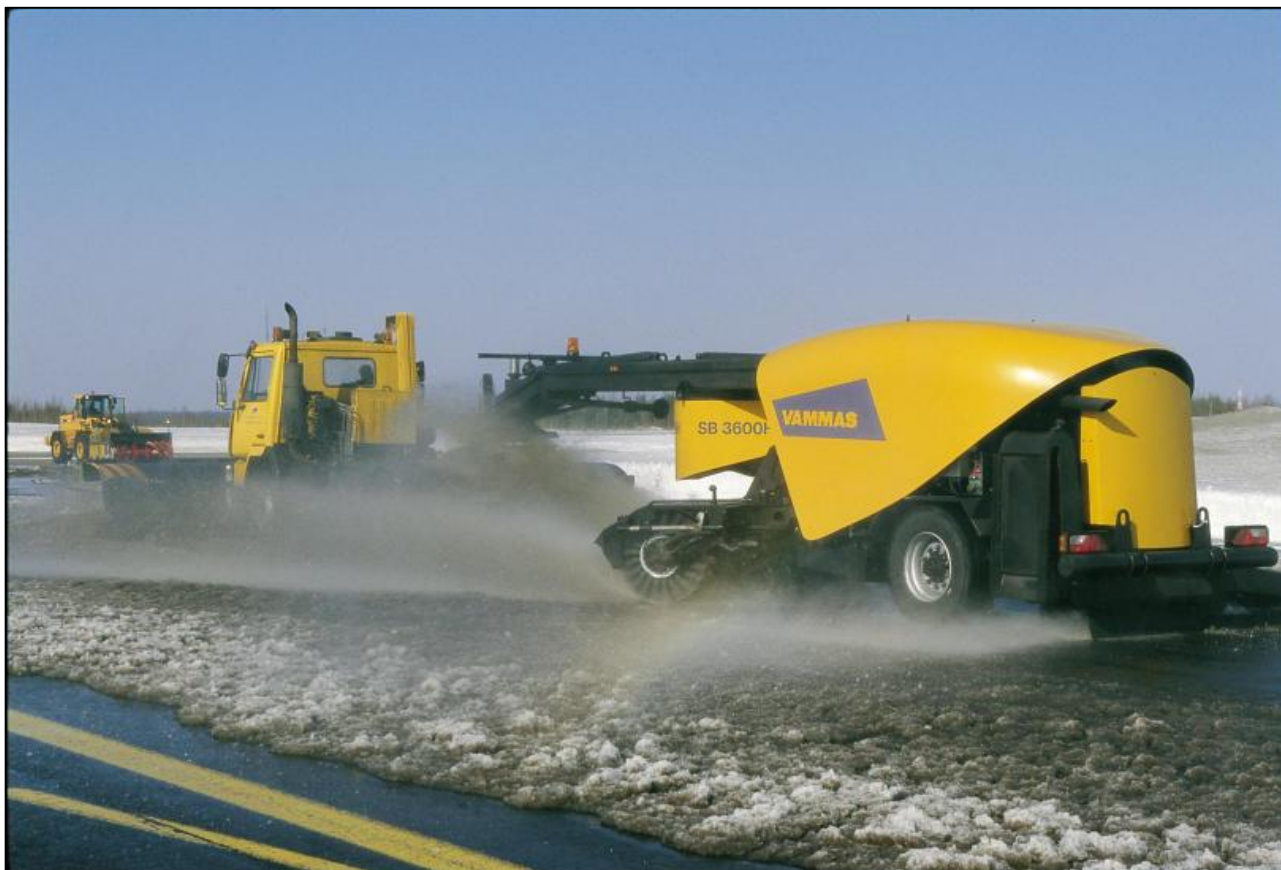
Bild 5. Vammas SB 3600H2 borstblåsare kopplad till dragbil. (Bild: Fortbrand Services Inc.)
