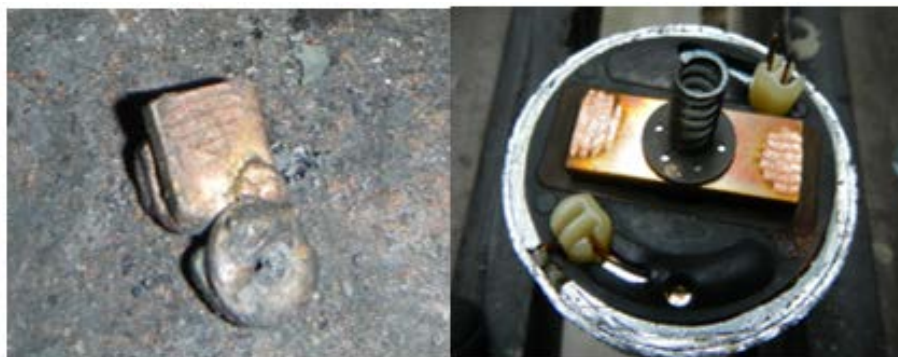
Figur 23. Det kortslutna kopparblecket borttaget ur solenoiden till vänster och kopparbleck ur en oskadad likadan startmotor till höger.
