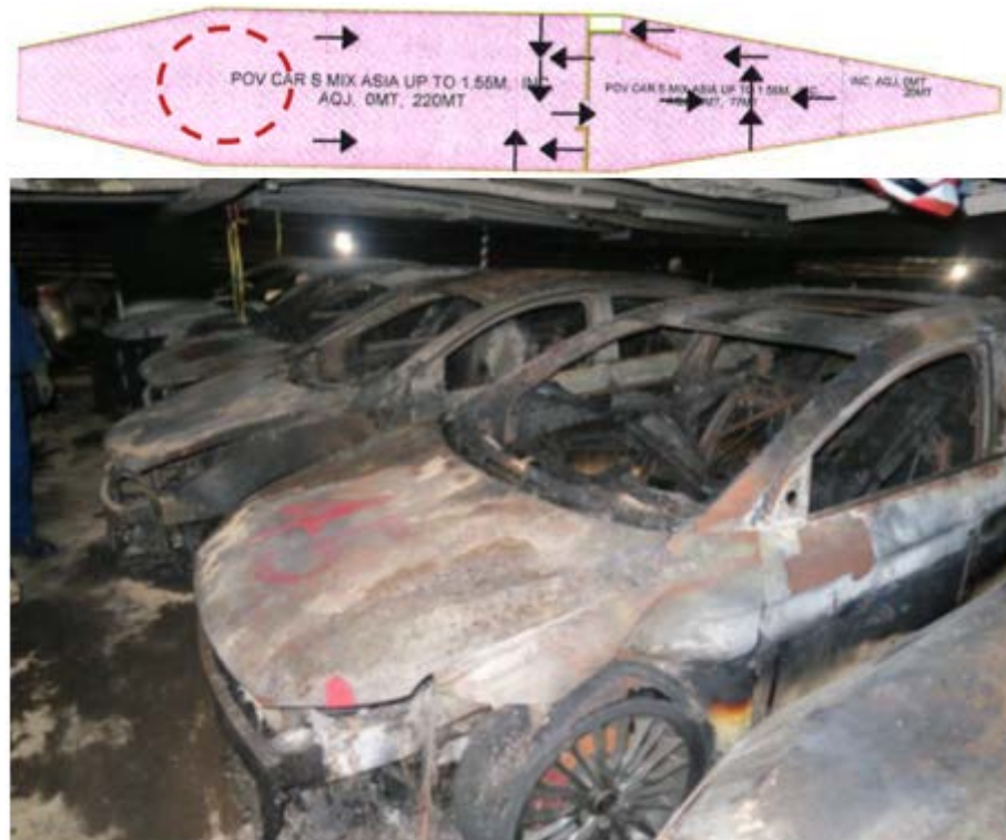
Figur 17. Området där branden sannolikt startat, den streckade cirkeln i däckskissen. Här syns också den märkning, siffrorna på motorhuv, som gjordes på bilarna för att lättare kunna referera till de olika bilarna.
