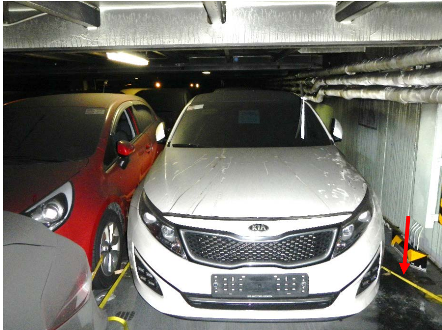
Figur 12. Bilarna stod mycket tätt. På bilden syns också de gula surrningsbanden mellan last- rumsdäcket och hjulen, pilen till höger.
