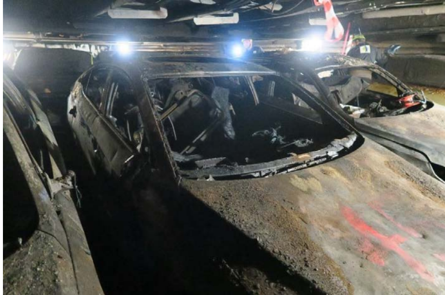
Figur 29. Den bil med taklucka varifrån branden inne i bilen har påverkat hydraulrör och kabeldragningar i däckets ovanför.
