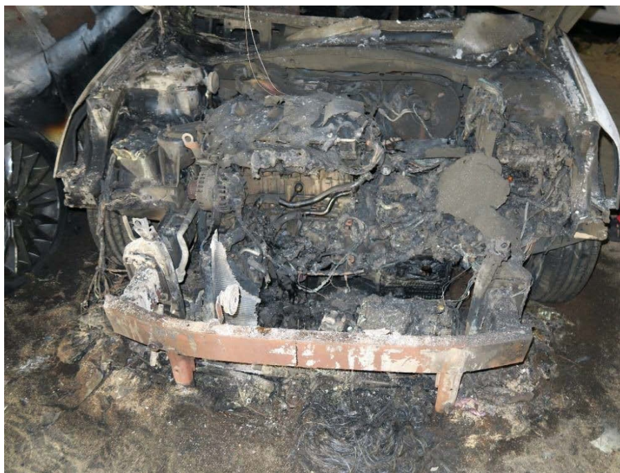
Figur 19. Motorrummet i den bil där branden sannolikt har startat.
