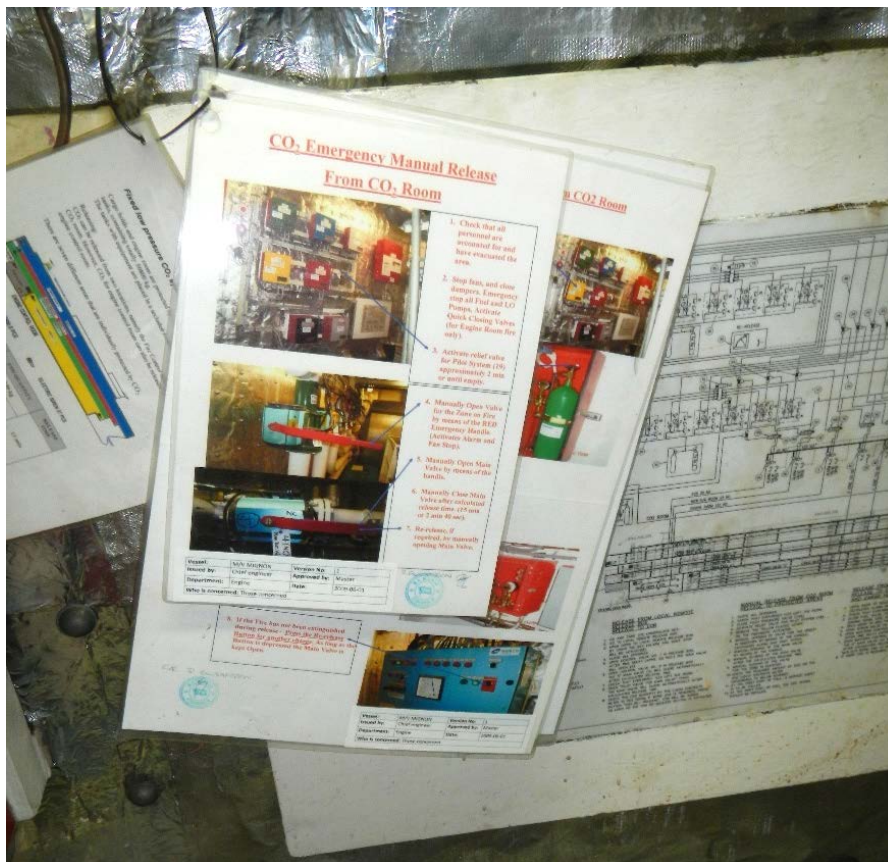
Figur 16. Bilden ovan visar de två instruktionerna i CO 2 -rummet vid maskinrummet. Instruktionen som hänger längst fram med fotografierna är den som var framtagen på fartyget. Instruktionen på den vita skivan bakom, utan fotografier, var den som tekniska chefen använde.
