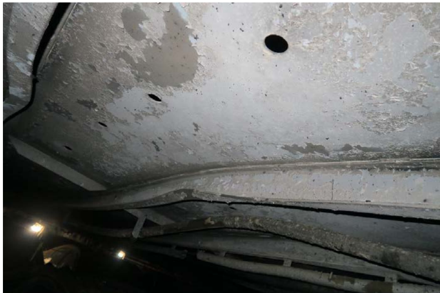
Figur 30. Lastsäkringshål i däcksplåten upp mot däck två.
