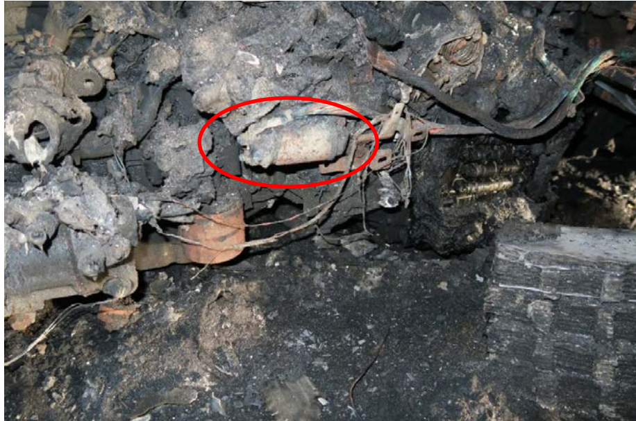
Figur 20. Solenoiden på startmotorn där branden med all sannolikhet startat.
