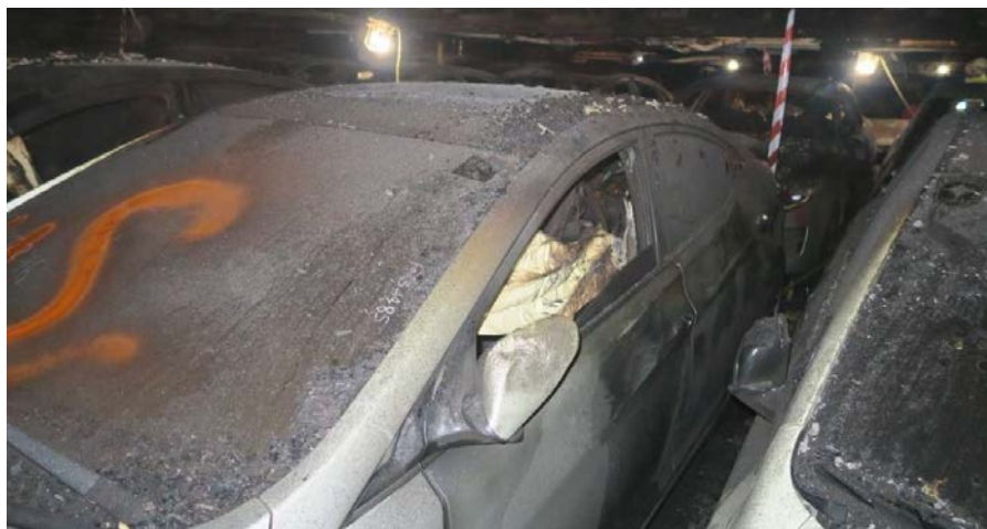
Figur 27. Nervevad ruta på förarsidan. Notera den aktiverade airbagen och det korta avståndet mellan bilarna.
