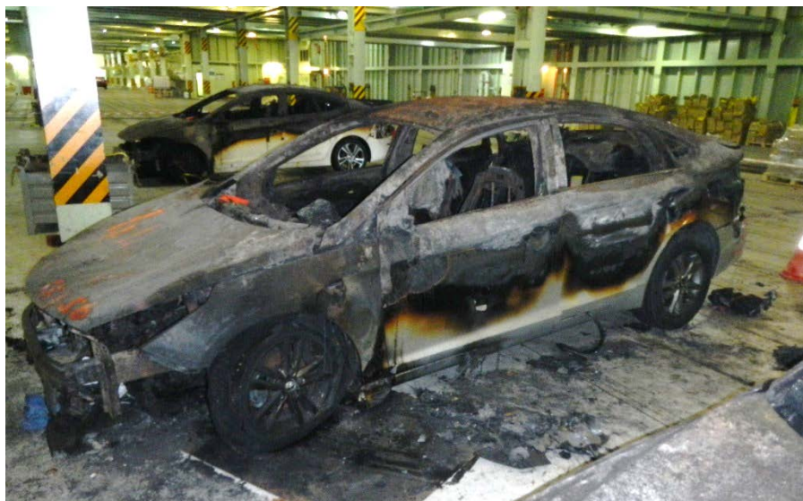
Figur 18. Brandmönstret på den bil där branden sannolikt startat. På bilden är bilarna flyttade från däck 1 till ett oskadat däck högre upp i fartyget för fortsatt undersökning.
