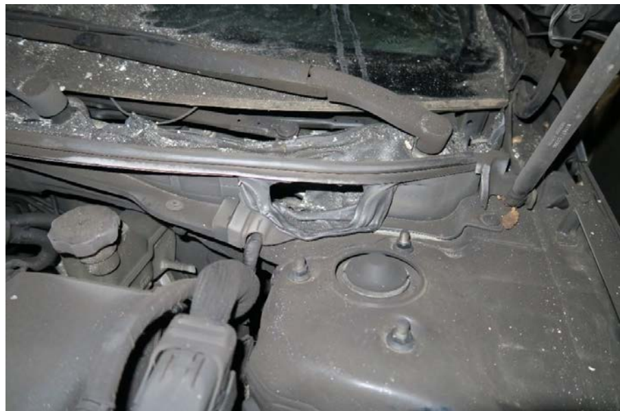
Figur 26. Hålighet mellan motorrum och kupé där plasten smält
