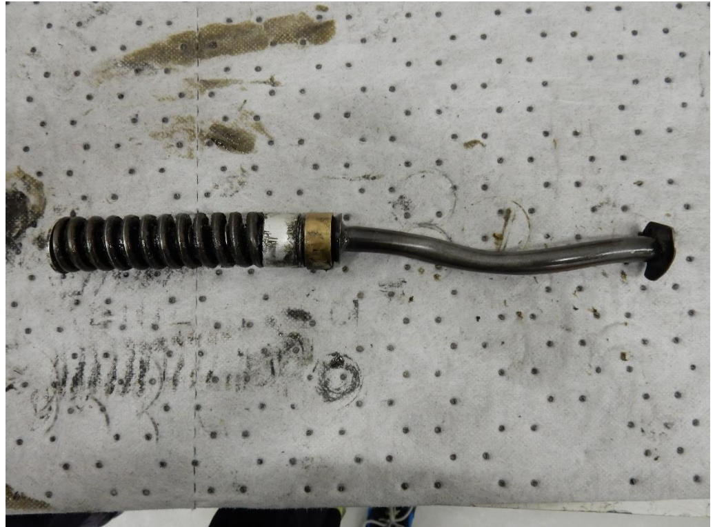
Figur 9: Del av fjäderpaketet och den deformerade konhållaren.
