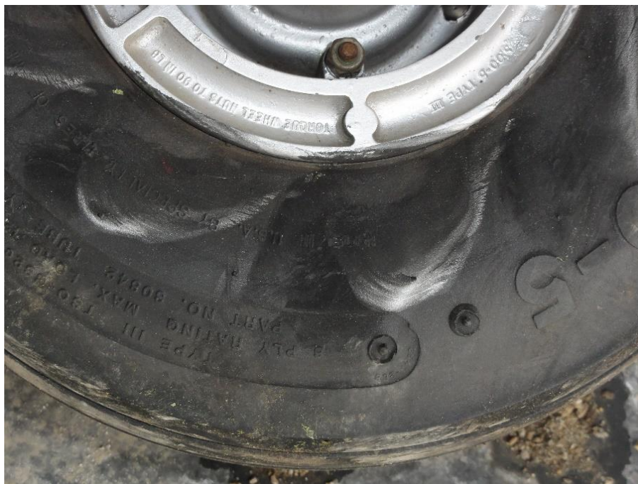
Figur 7. Spår på däckets från hjulkåpan.
