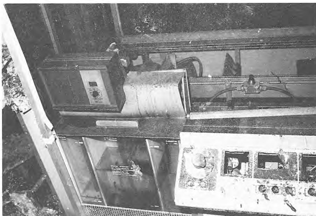
Figur 9 Lödmaskinens manöverpanel. Till vänster syns vätskebehållarna, vilka innehåller isopropanol och flussmedelslösning. Vätskenivån syns på bilden. Till vänster på manöverpanelen syns den knapp som skadats av strålningsvärmern
