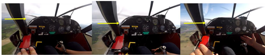
Figur 5. Samtliga bilder är tagna med full gas och ett stabilt flygläge. Den vänstra bilden visar stigning med full klaff och mittenbilden stigning med infälld klaff. Den högra bilden visar stall med full klaff.
