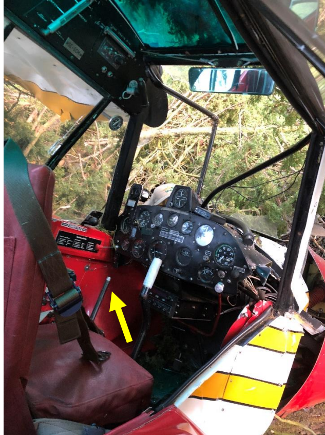
Figur 4. Förarkabinen. Notera att klaffspaken, vid den gula pilen, står i läget för fullt utfälld klaff. Foto: Vikingstads brandstation.
