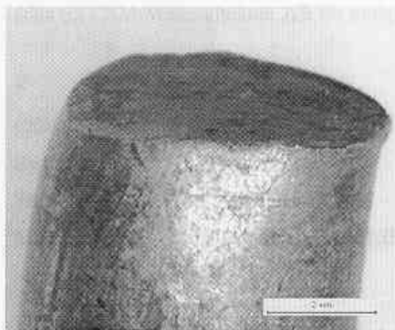
Figur 2 x10 Brottet sett från sidan visade att bultens skaft var kraftigt deformerat intill brottet.
