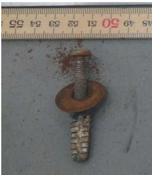
Fig. 5. Typisk infästning. På bilden ses skruven inskruvad en bit i rampamuffen.
