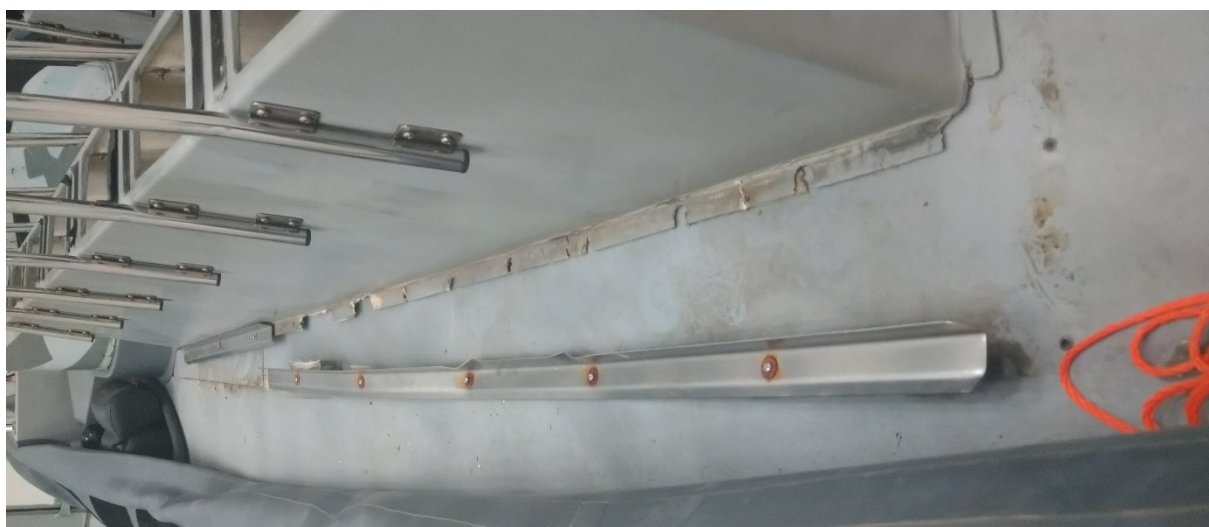
Fig. 6. Styrbords bänkrad med de två rostfria plåtarna. Den aktra satt kvar i bänken och slets loss ur durken.
