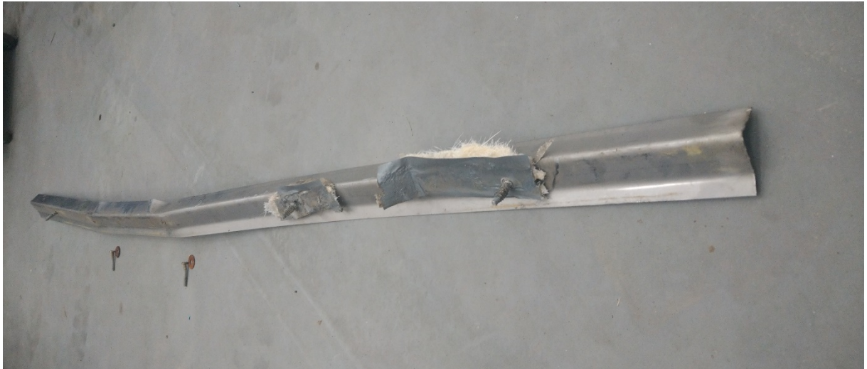
Fig. 7. Den förliga rostfria plåten till styrbords stolsrad. De två skruvarna bredvid var kvar och iskruvade i durken, de övriga tre hade ryckts loss. Under plåten ses två bitar med glasfiber och vävtejp från bänkens fästfläns.
