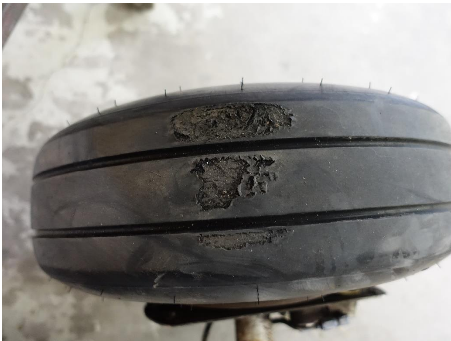
Figur 16. Skador på vänster däck av en så kallad ”gummireversion”.
