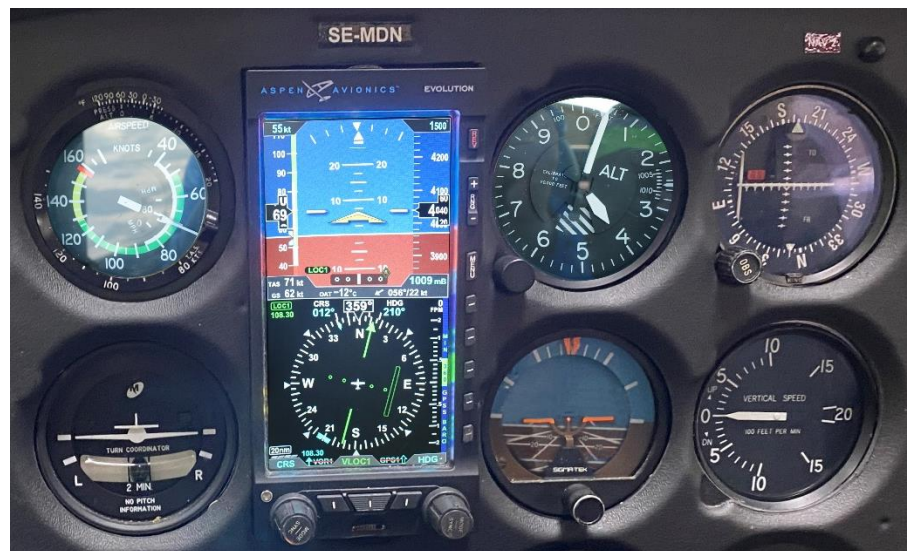
Figur 3. Instrumentering i SE-MDN med Aspen Avionics EFD 1000 som ett komplement till de primära flyginstrumenten.
