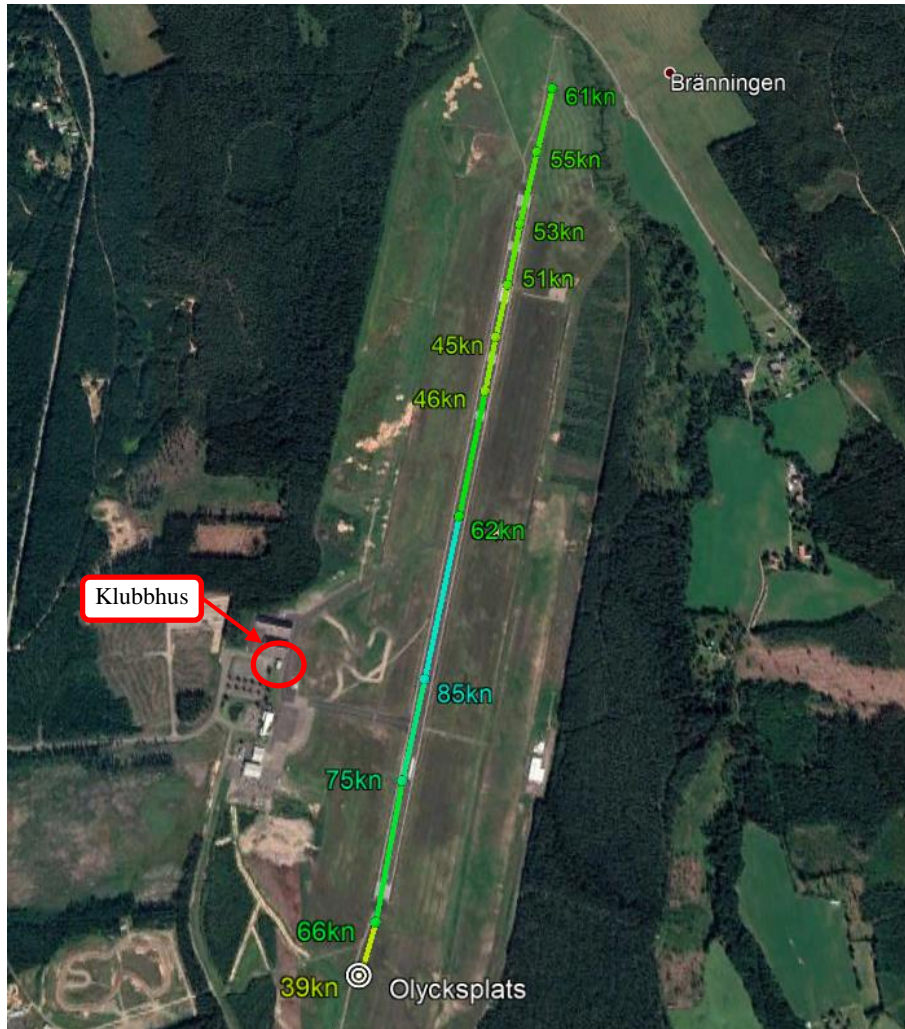
Figur 7. Landningen följt av den avbrutna starten. Varje punkt representerar medelhastigheten (färdhastigheten över marken) beräknad från föregående punkt. Bild: Google Earth med markeringar infogade av SHK.
