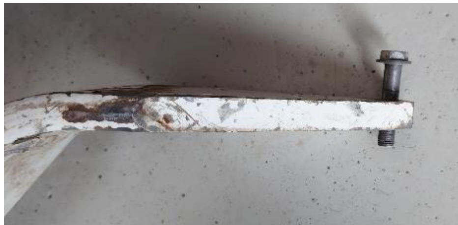
Figur 21. Landställsben med skruv för infästning.
