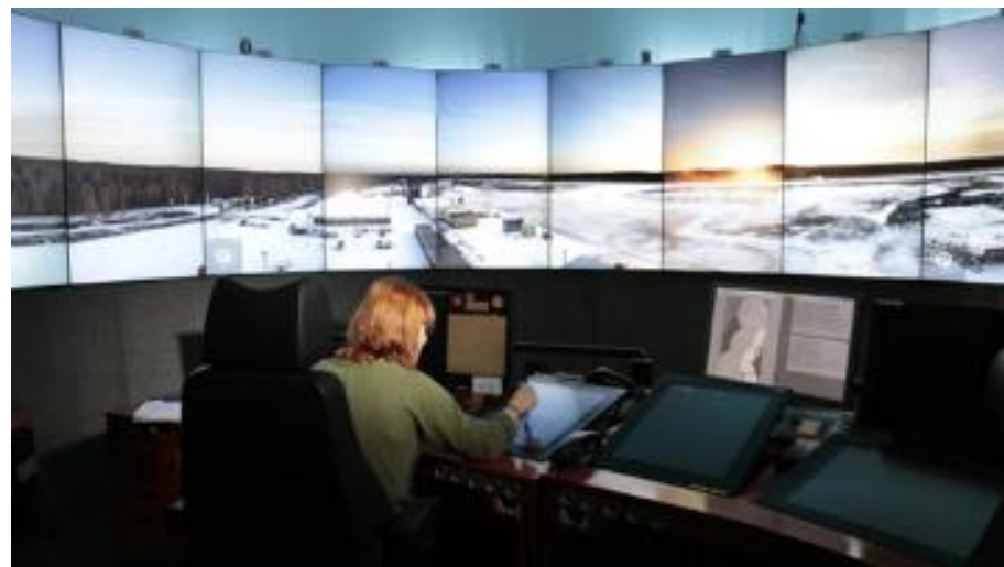
Figur 8. Flygtrafikledarens position i RTC-centralen i Sundsvall (konceptbild). Källa: Saab AB.
