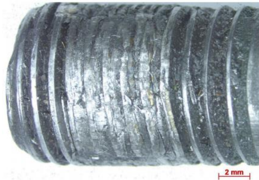
Figur 26. Förstoring av skruven med deformerade gängor och metalliskt material i gängorna.
