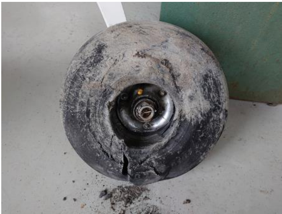
Figur 23. Höger hjul med skador.
