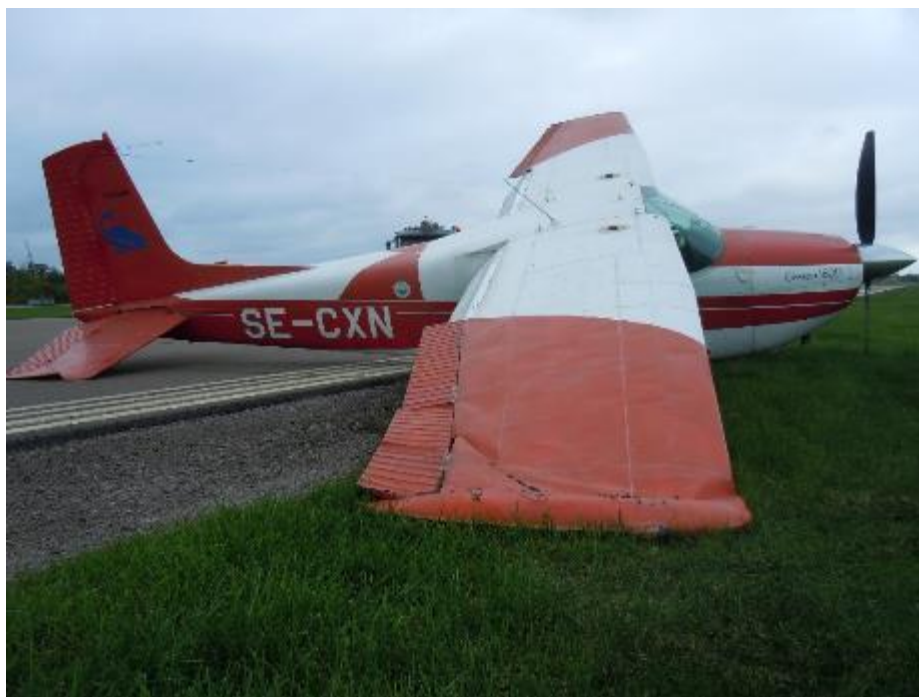
Figur 19. Skador på höger vinge och skevroder. Foto: Saab räddningstjänst.
