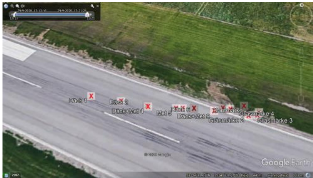
Figur 17. Spår på banan från första märket till slutpositionen norr om banan (däck och metall). Haverikommissionens mätningar av banan överlagda på bild från Google Earth.
