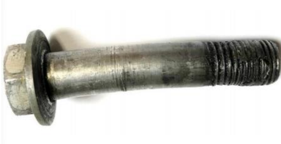
Figur 25. Skruv för infästning av landstället.
