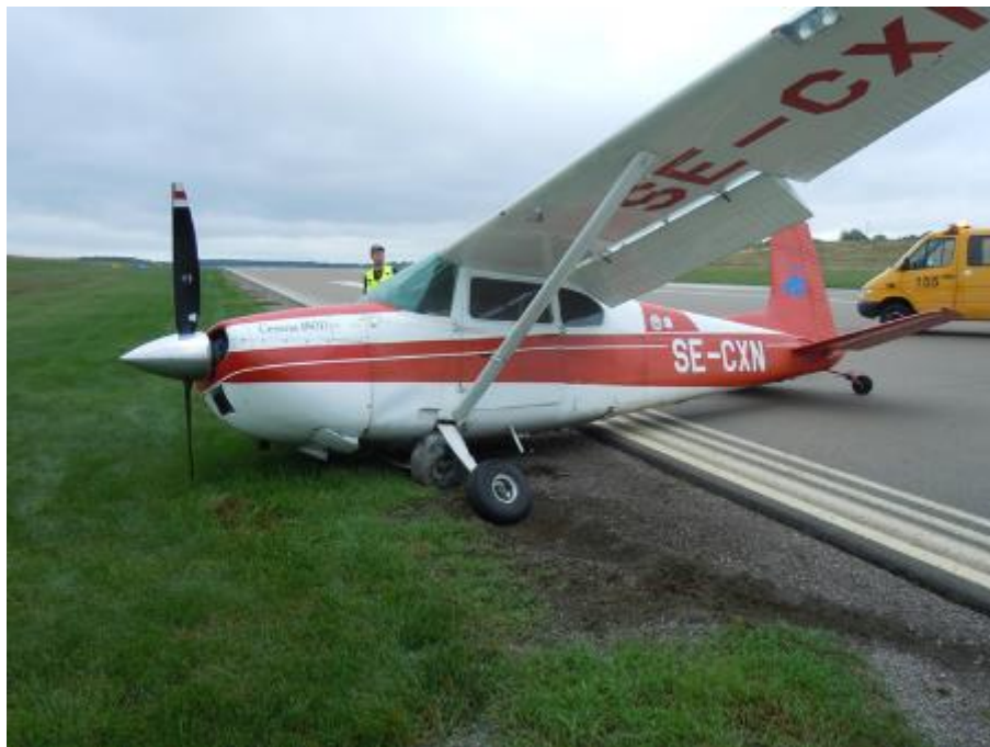
Figur 18. Höger landställ vikt under flygkroppen. Foto: Saab räddningstjänst.
