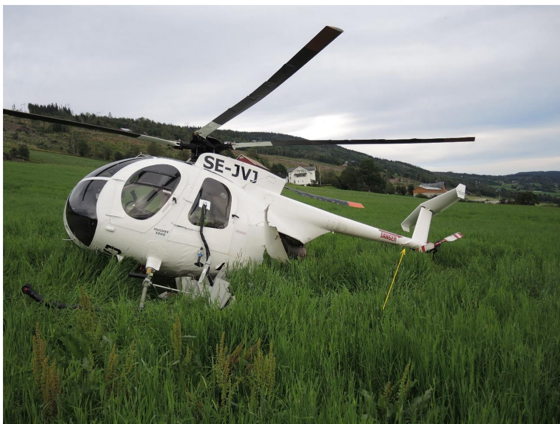
Figur 6: Rigger med kartleggingsutstyret og rynker i platehuden sees under helikopteret. Vridningen i halebommen er merket med gul pil. Foto: SHK
