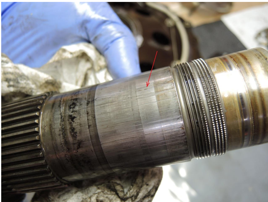
Figur 10: Eksempel på riper der lagrene har sittet på akseltappen som driver halerotoren. Foto: SHK
