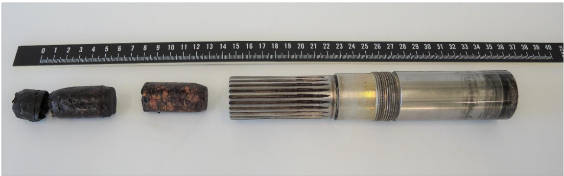
Figur 12: Den inngående akseltappen etter at enden med bruddflaten var kuttet av. Til venstre to vinkorker, hvorav den venstre har gått delvis i oppløsning og delt seg i to deler. Foto: SHK
