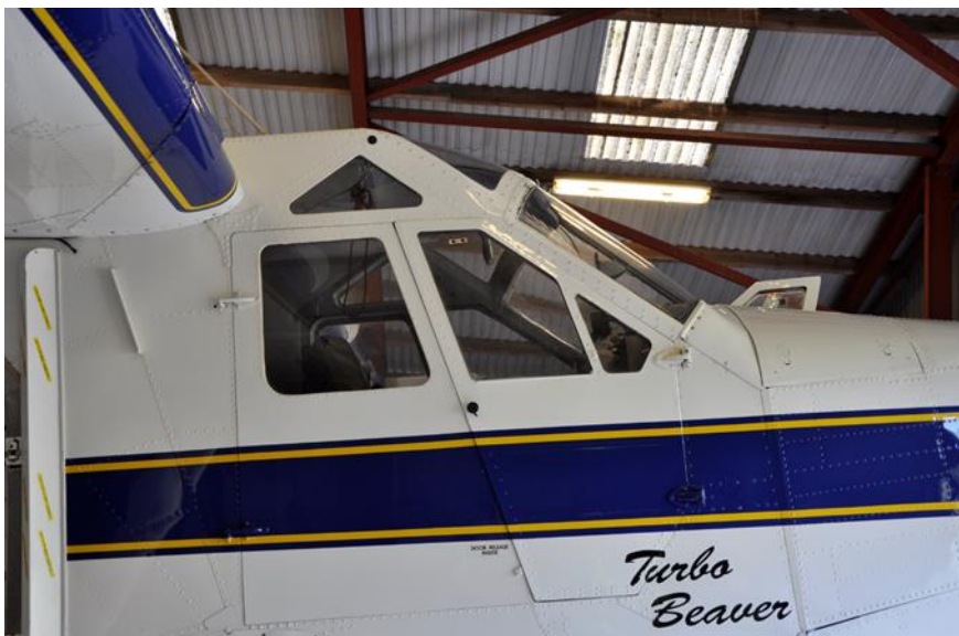
Figur 5. SE-KKD cockpitfönster med fönsterramar.
