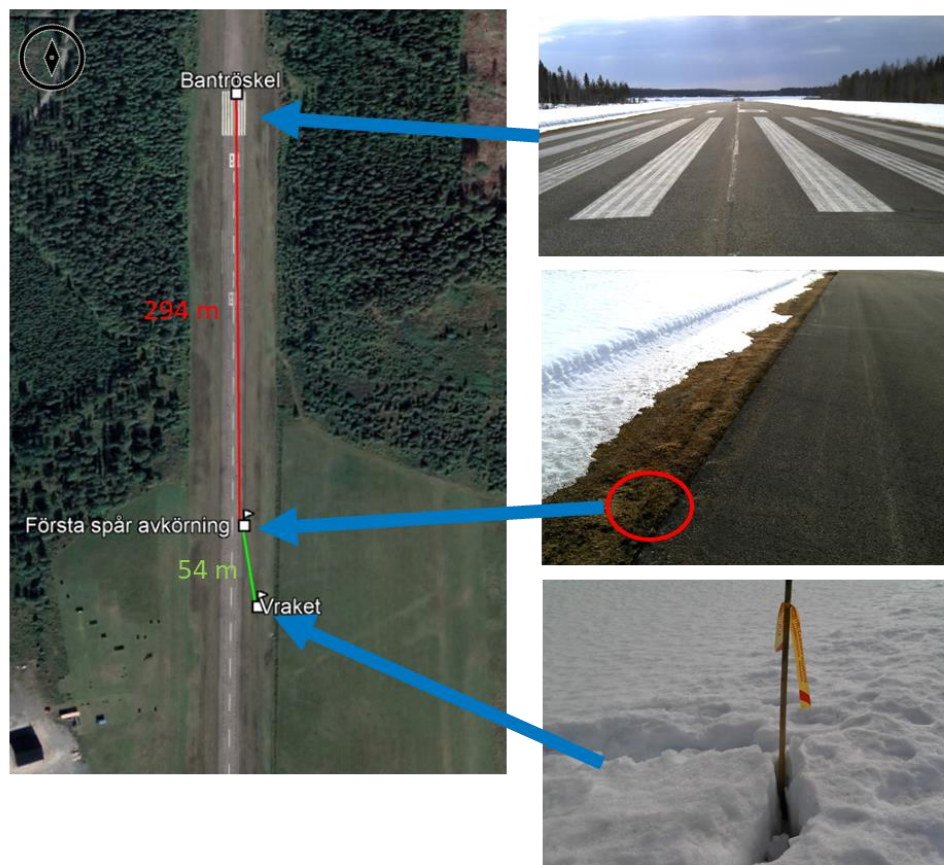
Figur 4. Illustration av olycksförloppet baserat på pilotens berättelse och spår på stråket. Markeringar infogade av SHK. Bilden till vänster: Google Earth.
