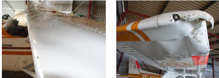
Figur 8. Bucklor och deformationer på flygplanets vingar.
