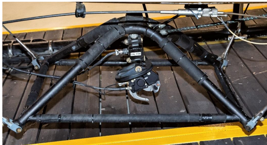
Figur 2. Hänglastutrustning med en lastkrok.
