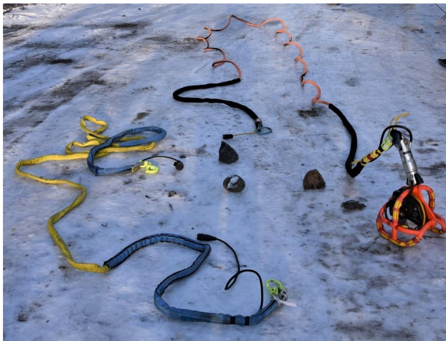
Figur 3. Slingan med en nedre krok (till höger) samt den 10 meter långa förlängningsslingan.
