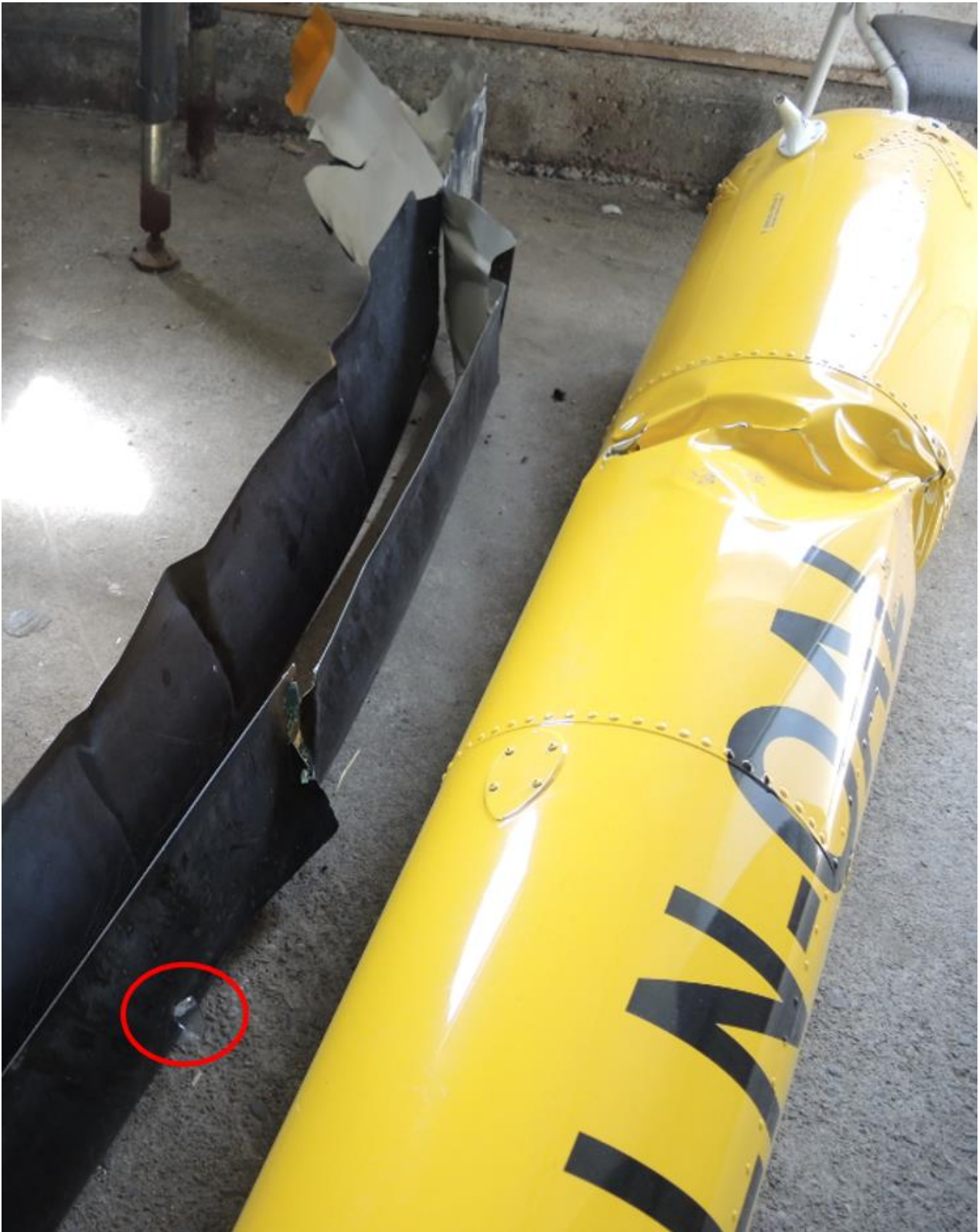
Figur 5: Hovedrotorbladene og halebommen. Et pleksiglasskår på undersiden av det ene hovedrotorbladet (rød innringing) tyder på at rotorbladet har slått ned i venstre frontrute. Foto: Statens havarikommisjon
