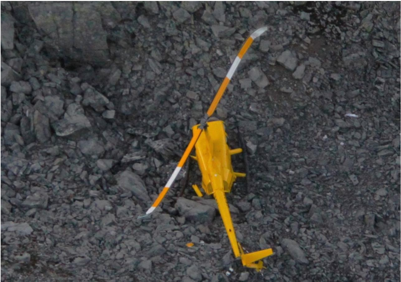
Figur 2: LN-OAL på ulykkesstedet. Bildet viser at halebommen er slått skjev mot høyre. Videre vises at venstre meie (skid) er knekt, og at både hoved- og halerotorbladene er skadet. Foto: Midtnorsk Helikopterservice AS
