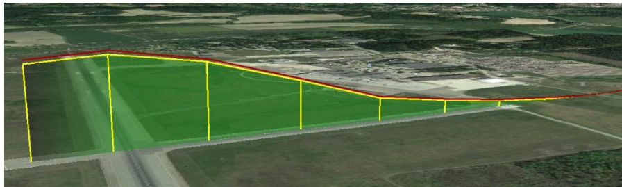
Figur 16. GPS-Data över glidflygning från simulerat motorbortfall på 300 fot över banan.
