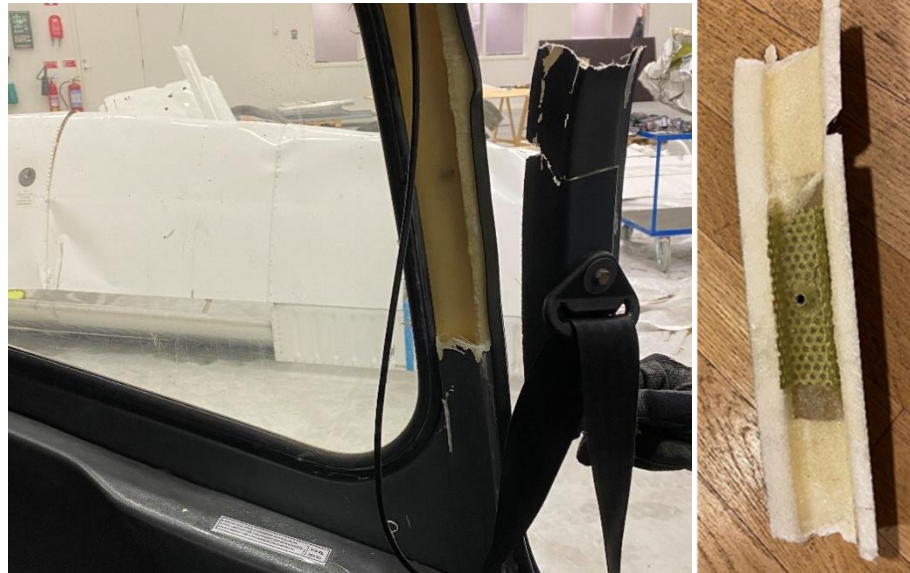
Figur 15. Den avslitna bältesinfästningen på vänster sida.
