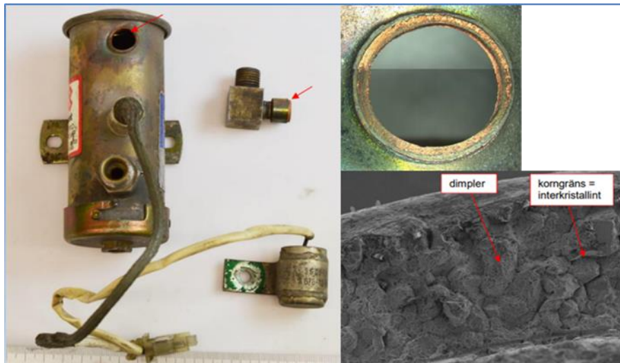
Figur 14. Bilden till höger: Bränslepump och avskild nippel. Pilarna visar brottytorna i lödfogen. Övre höger bild: Brottytan på pumpen. Undre höger bild: SEM 13 bild av brottytan på nippeln. Brottytan är interkristallin och uppvisar små kratrar (dimpel).
