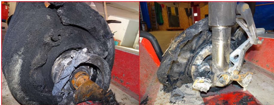
Figur 14. Bilder på vänster landställsben med fälg, däck och broms som brandhärjats.
