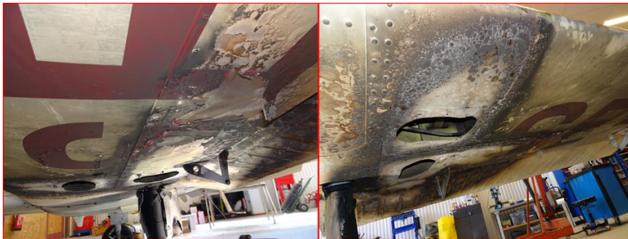
Figur 13. Bilder på undersidan av vingen som brandhärjats.
