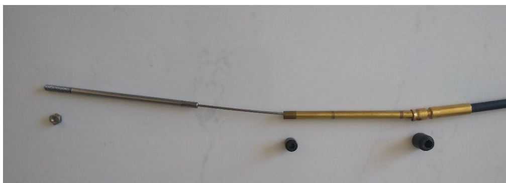
Figur 17. Änden på reglagekabeln. Ändhylsan tillåts röra sig några grader i en flexibel anslutning. Två gummitätningar finns för att skydda metalltråden från smuts.
