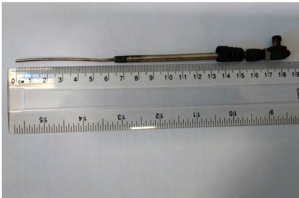
Figur 13. Den bit av reglagevajern som anslöt mot backslagets växelförare. Brottytan till vänster i bild. Till höger den kulle som skruvas fast på växelföraren.
