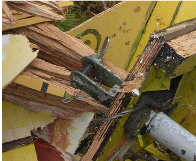
Bilden visar det ena av gaffeländstyckena på skevroderstötstängerna så som det återfanns på vraket.
