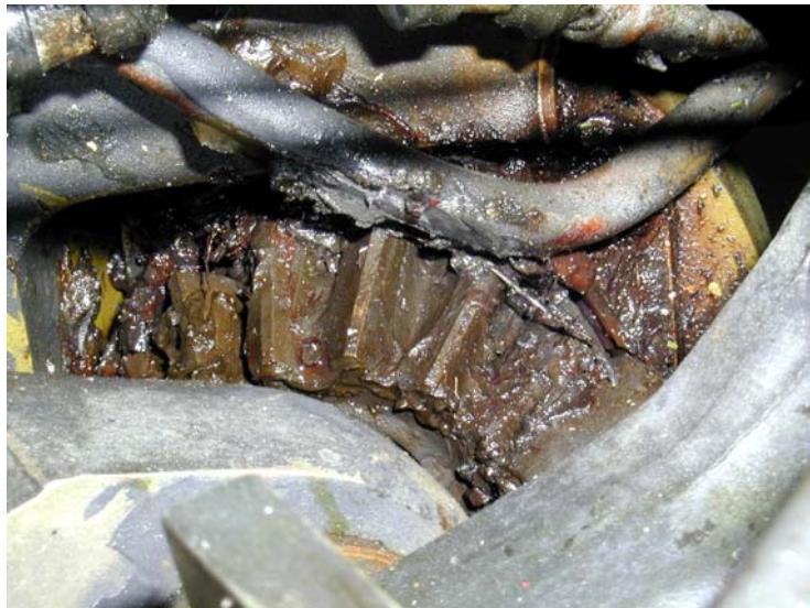
Kuggsegment och skadat hydraulrör
