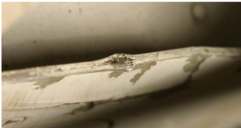
Skada på vingens undre skalplåt
