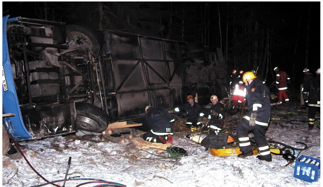
Arbete med lyftning och pallning av bussen
