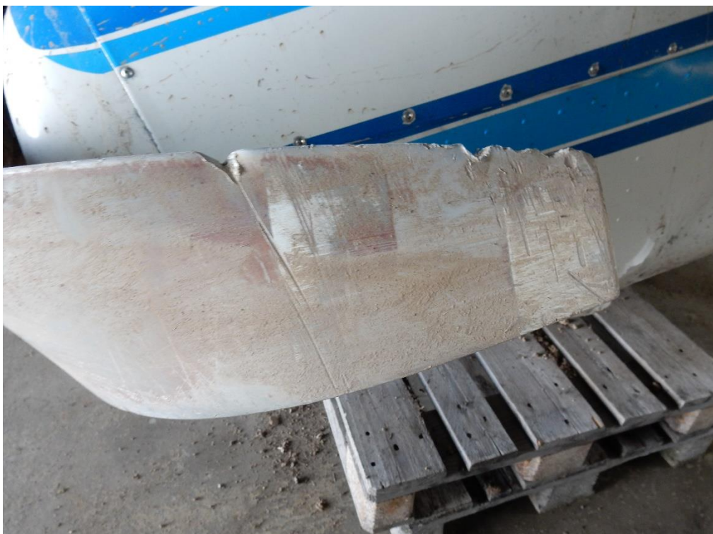
Figur 3. Skadat propellerblad med kraftiga hack.
