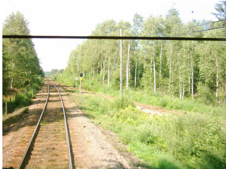
Utfarten från Torup i riktning mot Landeryd. Från höger kommer spår 30 från Hyltebruks-hållet. Den efter tillbudet uppsatta enskeniga utfartssignalen före växeln ses i mitten av bilden.
