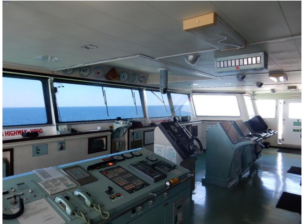
Figur 14. Interiör bryggan MAKASSAR HIGHWAY. Till höger i bild syns bl.a. radar och elektroniskt sjökort.
