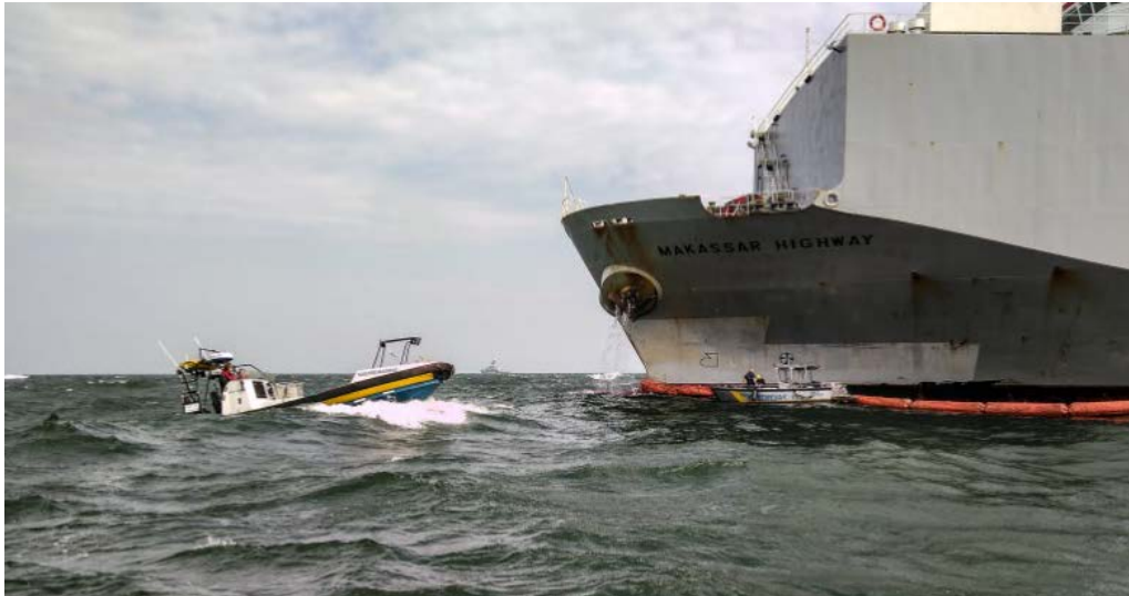
Figur 9. Vridande och ökad vind med högre sjögång medförde att fartyget vred sig på grundet. Notera länsan runt fartyget som har glidit upp mot fartygets för. Foto: Kustbevakningen.
