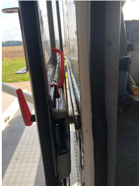
Figur 6. Bilden visar dörrhandtagets position i öppet läge på ett oskadat flygplan av samma modell som olycksplanet.
