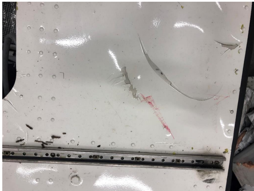
Figur 7. Slagmärke på flygkroppen av dörrhandtaget på SE-MES.
